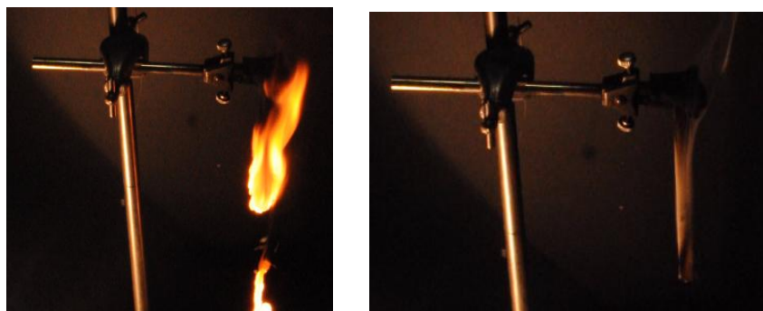
Próbka odlana z handlowej żywicy epoksydowej i próbka odlana z samogasnącej kompozycji epoksydowej
