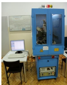
Dyfraktometr rentgenowski firmy EFG do badania orientacji krystalicznej nadstopów niklu
