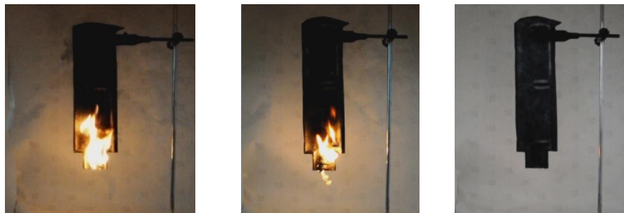
Wygląd płyta kompozytowego wzmocnionego włóknem węglowym z osnową: K24, K2 po 10 s od momentu usunięcia palnika oraz efekt wydmuchiwania obecny w laminacie z osnową K2
