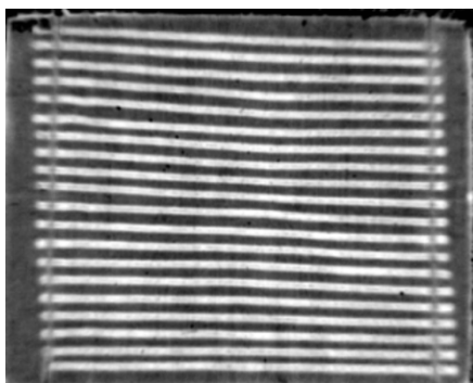
Obraz z kamery termowizyjnej dla struktury GFRP ze zintegrowaną siatką pomiarową.
