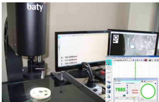
Stanowisko pomiarowe Venture firmy BATY i okno dialogowe rejestracji punktów pomiarowych koła planetarnego
