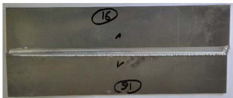
Zgrzeina liniowa - próbka połączenia doczołowego FSW blachy cienkiej z stopu AL2024T3
