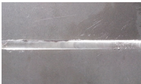
Magnez AZ31 grubości 1,6 mm zgrzany metodą FSW
