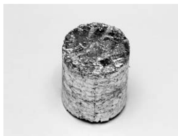
Brykiety ze sprasowanych wiórów ze stopu magnezu AZ61 oraz finalny wyrób wytworzony z prasówki na drodze konwencjonalnego prasowania
