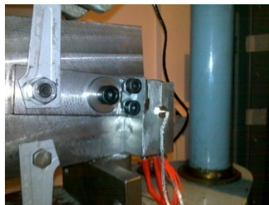
Stanowisko badawcze zamontowane na maszynie wytrzymałościowej
