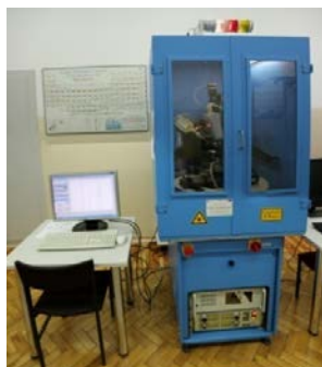
Dyfraktometr rentgenowski firmy EFG do badania orientacji krystalicznej nadstopów niklu
