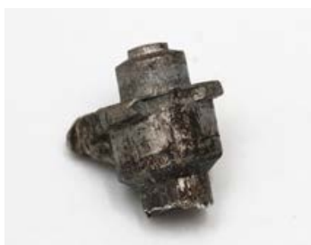
Brykiety ze sprasowanych wiórów ze stopu magnezu AZ61 oraz finalny wyrób wytworzony z prasówki na drodze konwencjonalnego prasowania
