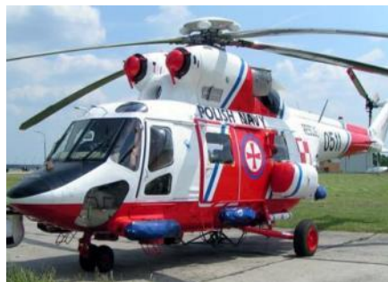
Helikopter Anakonda wyposażony w poduszki do lądowania na wodzie
