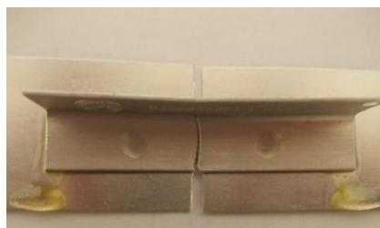
Próbka z klejem Epidian 100 oraz postać zniszczenia próbki z klejem Epidian 100
