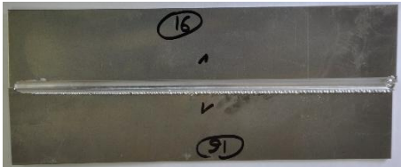
Zgrzeina liniowa - próbka połączenia doczołowego FSW blachy cienkiej z stopu AL2024T3
