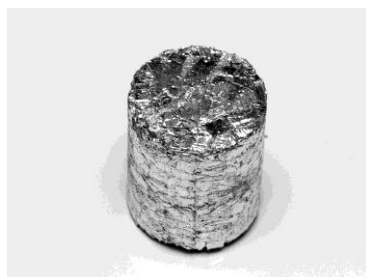
Brykiety ze sprasowanych wiórków ze stopu magnezu AZ61 oraz finalny wyrób wytworzony z prasówki na drodze konwencjonalnego prasowania
