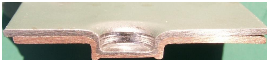
Przekrój wzdłużny złącza klinczowego
