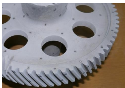
Optyczny skaner 3D ATOS II TripleScan i przygotowane do pomiaru walcowe koło zębate
