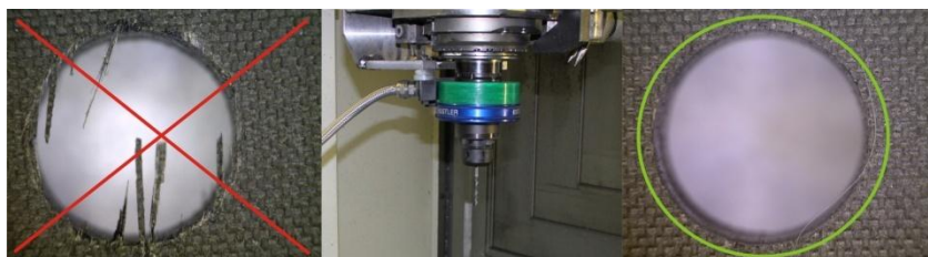
Otwór wykonany zwykłym wiertłem i wiertłem do materiałów kompozytowych
