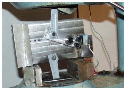
Stanowisko badawcze zamontowane na maszynie wytrzymałościowej
