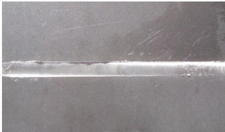
Magnez AZ31 grubości 1,6 mm zgrzany metodą FSW
