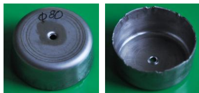
Wytłoczki otrzymane w wyniku wyoblania krążka o średnicy 80 mm (średnica wzornika 42 mm, materiał stop magnezu AZ31)
