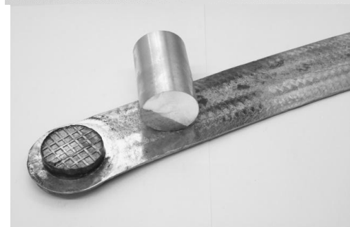
Wsad ze stopu magnezu AZ91 i płaskownik wyciśnięty na zimno metodą KOBO.
