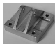
Trójsuwakowa prasa kuznicza, przykładowe narzędzia do kształtowania i przykładowe odkwyki płaskie z żebrami
