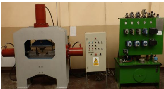
Trójsuwakowa prasa kuznicza, przykładowe narzędzia do kształtowania i przykładowe odkwyki płaskie z żebrami
