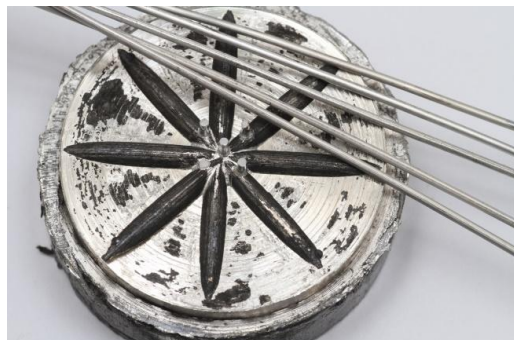
Drut ze stopu magnezu WE43 5x ø2mm wyciśnięty na zimno wielootworowo metodą KOBO.
