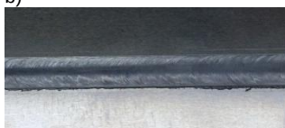
Zgrzeina liniowa - próbka połączenia doczołowego FSW blachy cienkiej z stopu:
