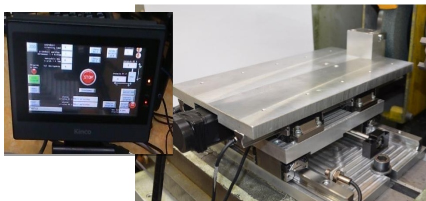
Prototyp przyrządu do profilowego kondycjonowania ściernic wraz z panelem sterującym HMI
