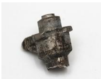
Brykiel ze sprasowanych wiórów ze stopu magnezu AZ61 oraz finalny wyrób wytworzony z prasówki na drodze konwencjonalnego prasowania
