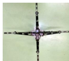
Uchwyt do mocowania próbek do symetrycznego dwuosiowego rozciągania na maszynach jednoosiowych
