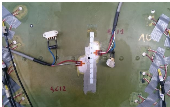
Przykład sieci PZT zainstalowanej na poszyciu belki ogonowej śmigłowca w celu monitorowania rozwoju pęknięcia zmęczeniowego
