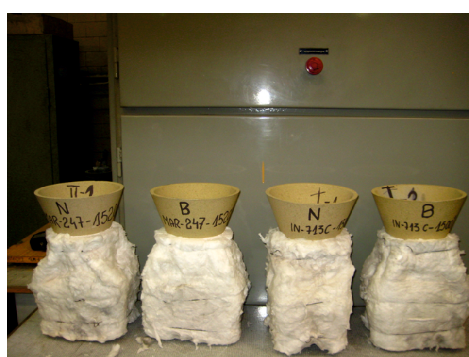
Rysunek. Forma niebieska i biała po ociepleniu Figure. Moulds blue and white after insulation
