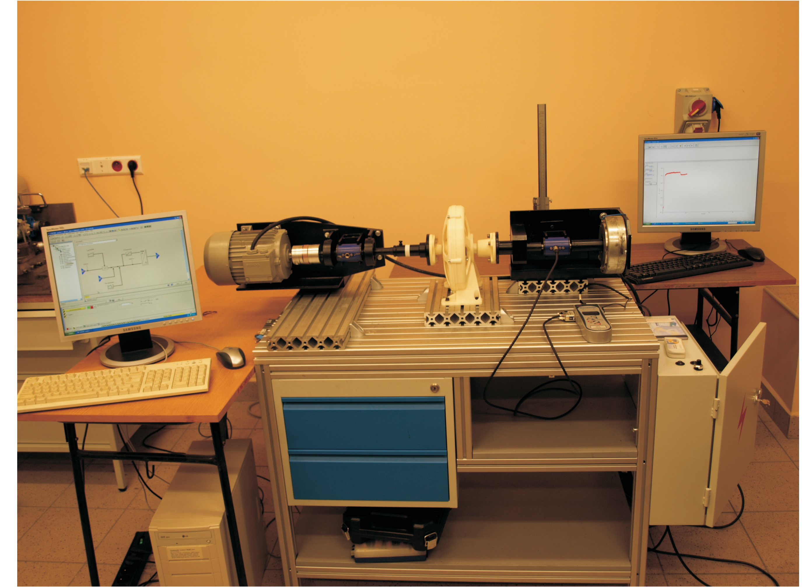
Rys. 9. Stanowisko badawcze z zamontowanym prototypem przekładni planetarnej Fig. 9. The test stand with fixed planetary gear prototype
