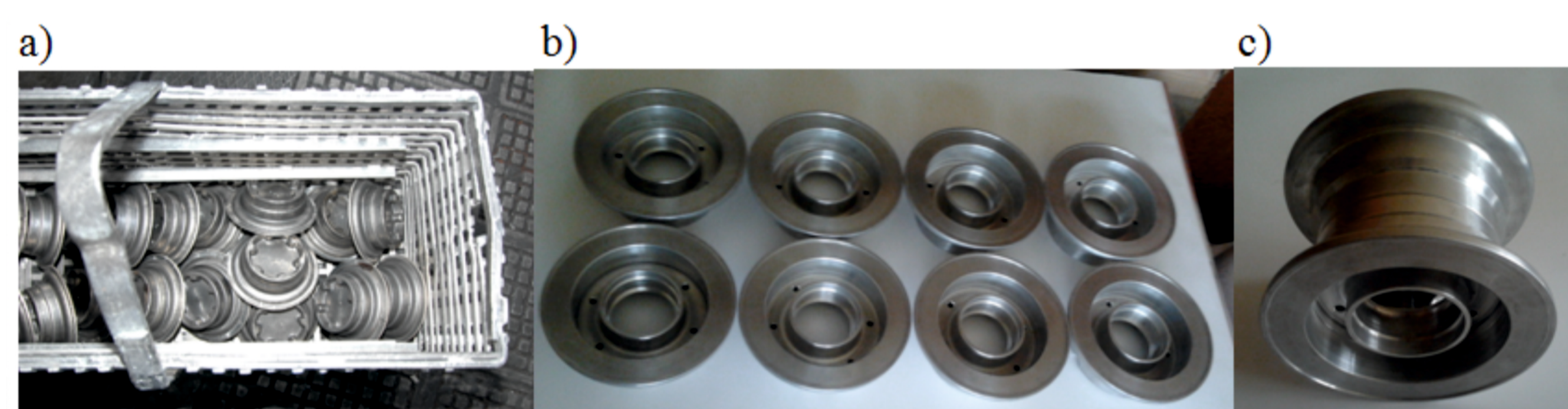
Rys. 2. Partia próbna odkuwek (a), półpiasty po obróbce mechanicznej (b), kompletna piasta ze stopu magnezu AZ31 (c)
