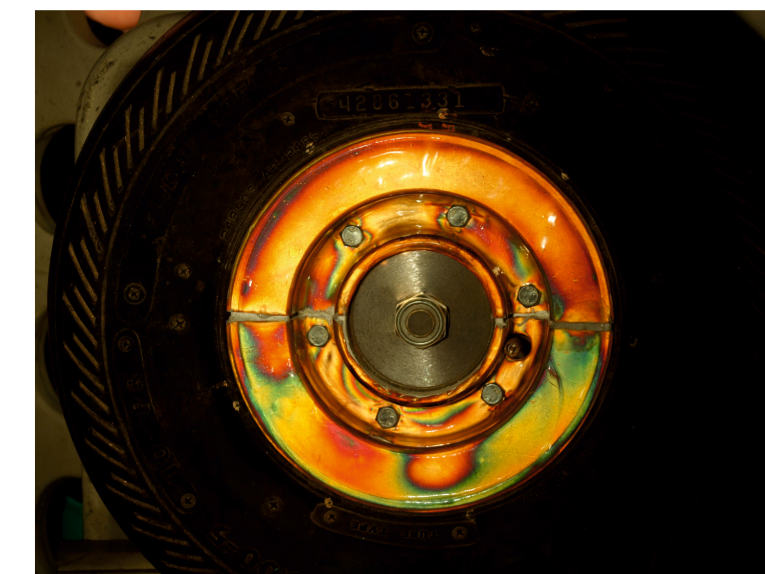
Rys. 6. Rozkład naprężeń w piastce koła samolotu - obciążenie siłą pionową Fig. 6. The distribution of stresses in the aircraft wheel hub - vertical force load
