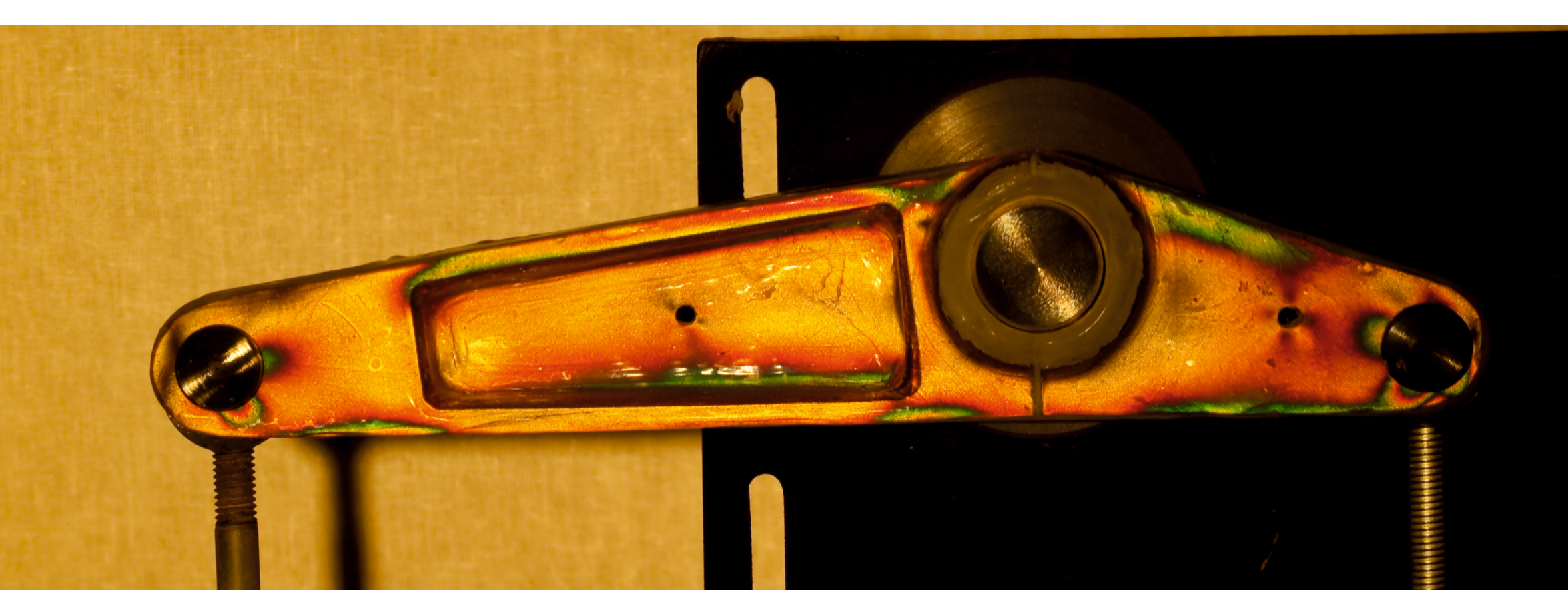
Rys. 5. Rozkład naprężeń w dźwigni układu sterowania śmigłowca - metoda światła odbitego - obciążenie: 1, 3, 6 kg. Fig. 5. The distribution of stresses in the helicopter control lever - the method of the reflected light - load: 1, 3, 6 kg.
