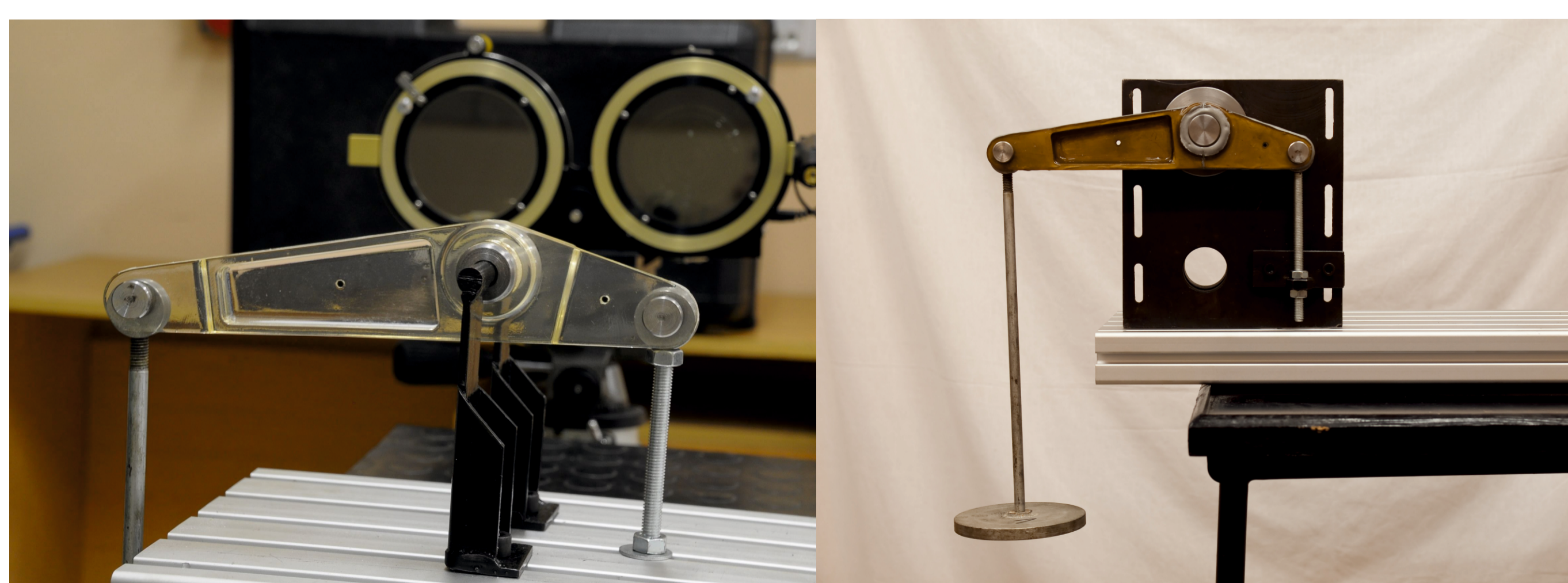
Rys. 3. Stanowisko do analizy rozkładu naprężeń w dźwigni - metoda światła przechodzącego i odbitego Fig. 3. Positions to analyze the stress distribution in the lever - the method of the transmitted and the reflected light
