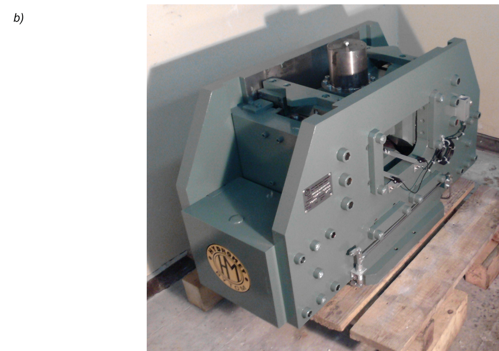
Rys.5. Przyrząd do kształtowania plastycznego wspomaganego oddziaływaniem naprężeń ścinających a) schemat przyrządu b) widok ogólny
