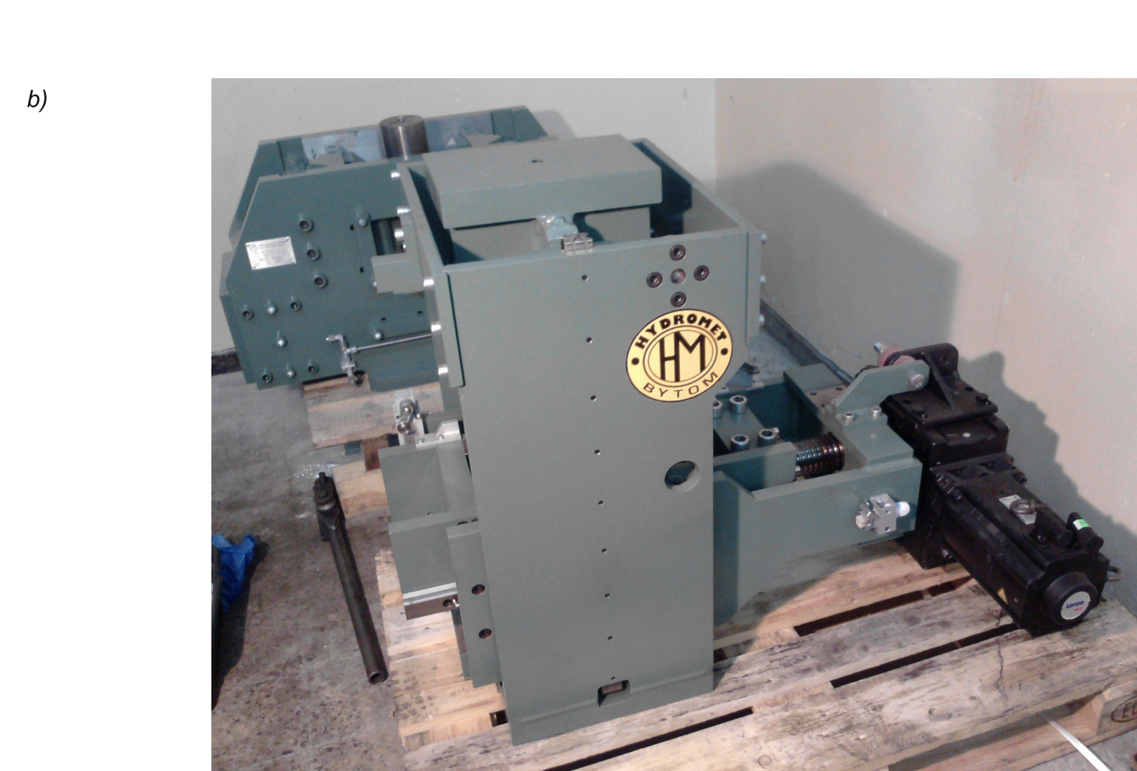
Rys.6. Przyrząd do kształtowania segmentowego z posuwisto-zwrotnym ruchem rolek roboczych a) schemat przyrządu, b) widok ogólny
