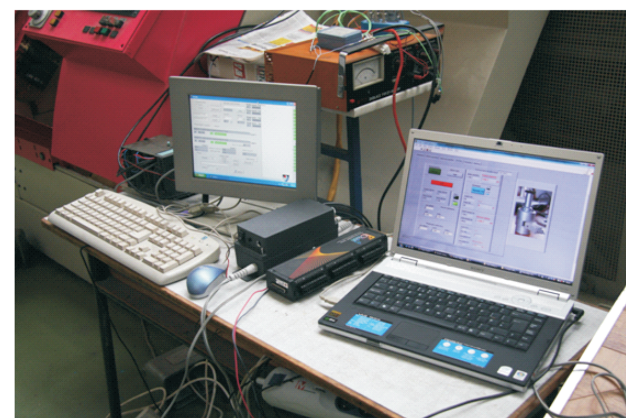
Rys. 5 Simatic S7 i PW02 - pomiary równoległe na tokarce Famat 400 CNC.
