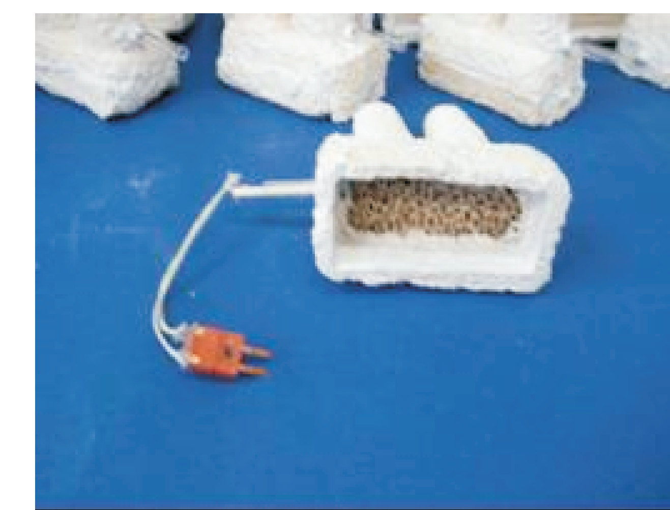
Forma z zamontowanym czujnikiem temperatury Pt-PtRh10
