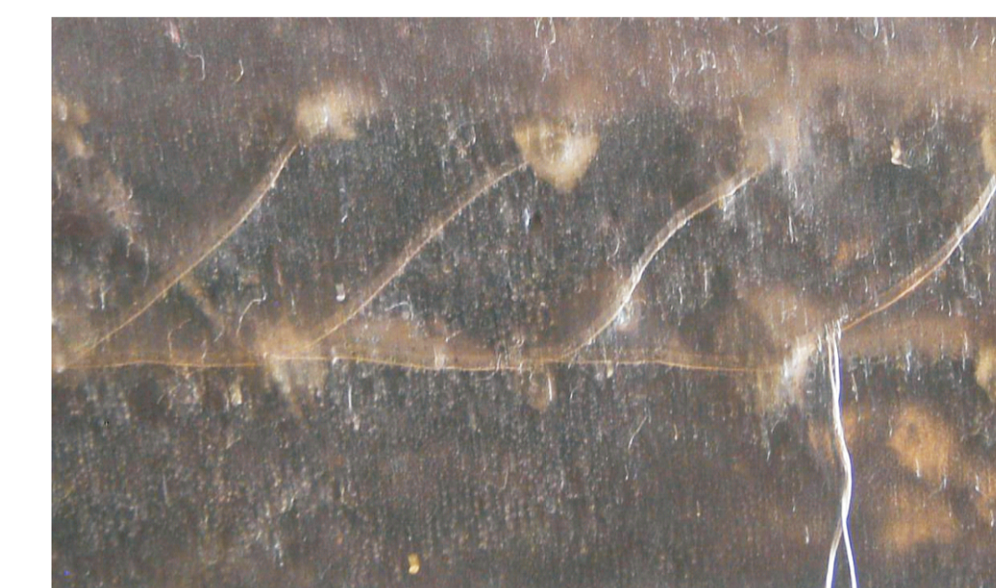
Rys. 4. Próbkę kompozytu z zatopionym układem drutów przewodzących.
