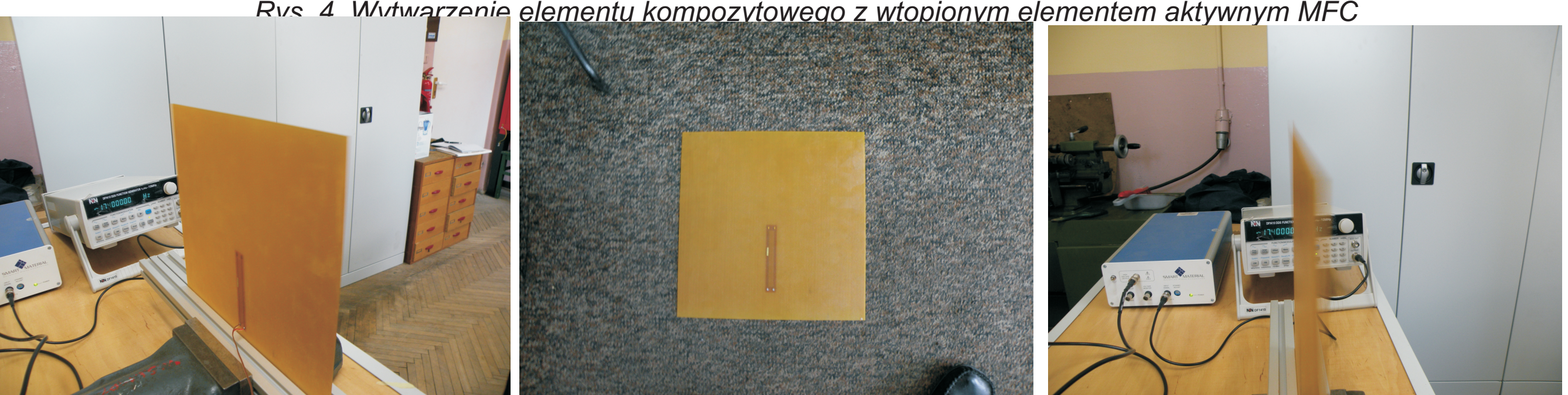
Rys. 5. Gotowy element kompozytowy z wtopionym elementem aktywnym MFC oraz badania laboratoryjne
