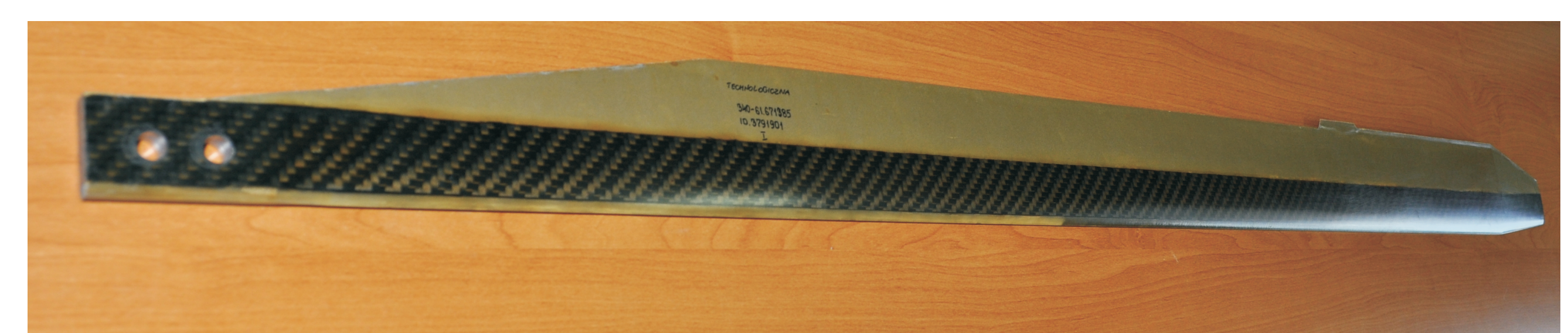
Rys. 6. Gotowy model kompozytowej łopaty wirnika nośnego
