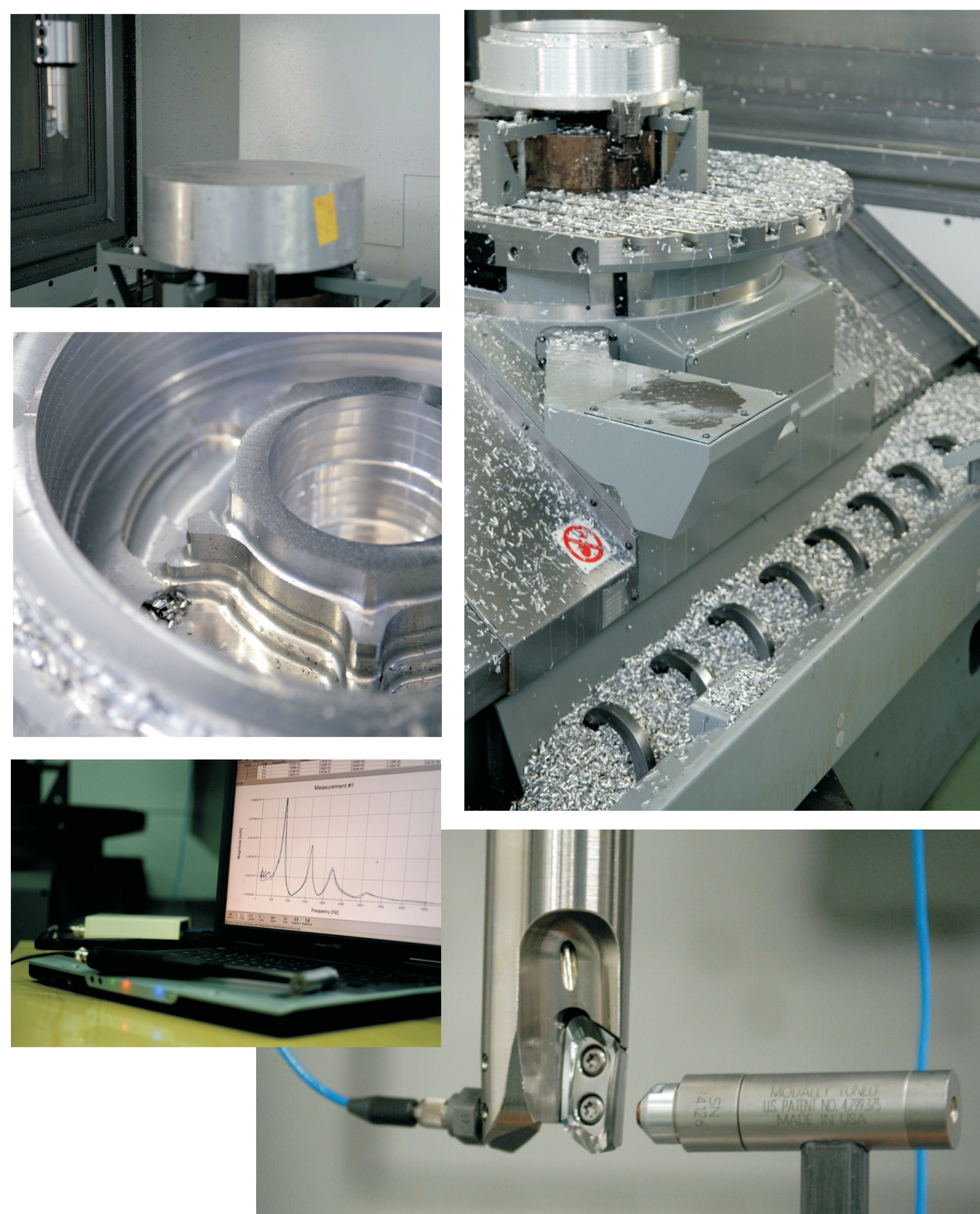
Rys.1. Pomiar i analiza procesu frezowania HSC elementów typu Pocket na frezarce DMG80P DuoBlock
