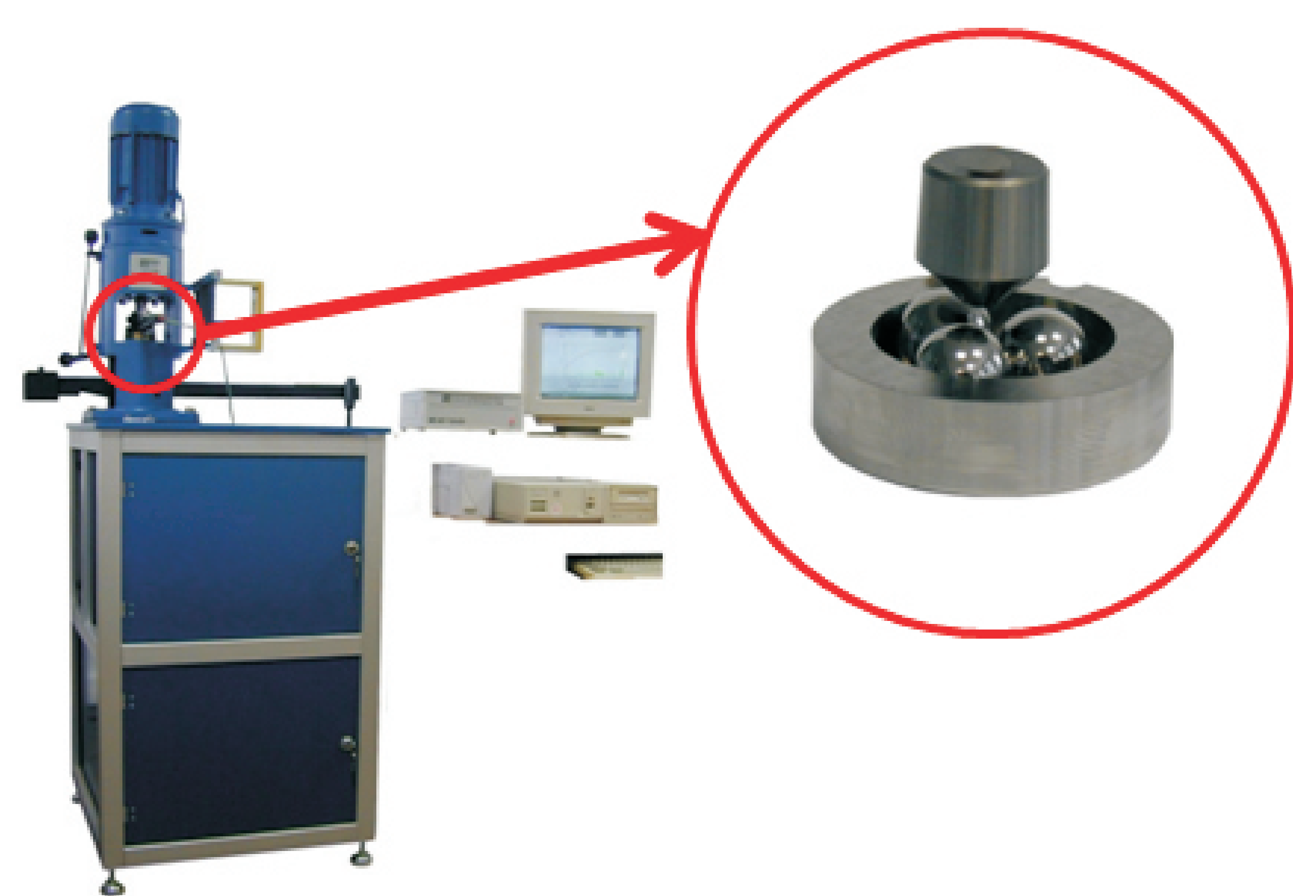
Rys.1. Zmodyfikowany aparat czterokulowy dla realizacji badań powierzchniowej odporności na zmęczenie stykowe wg IP 300/82
