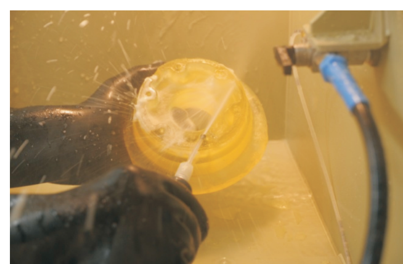
Rys. 2.10. Wypłukiwanie materiału podporowego przy użyciu dyszy: a) grubej, b) cienkiej
