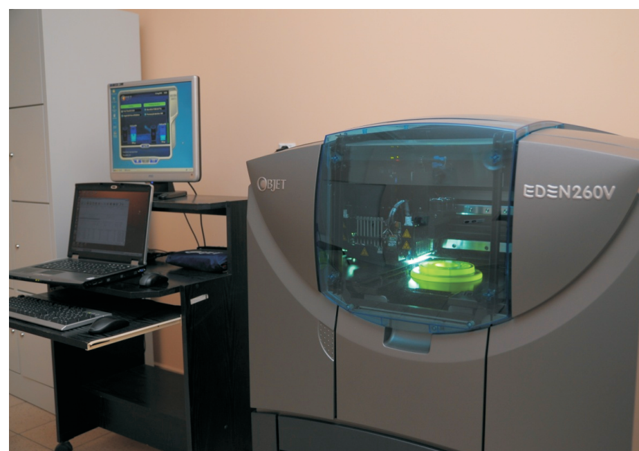
Rys. 2.5. Aparatura Objet Eden 260V podczas wydruku modelu piasty
