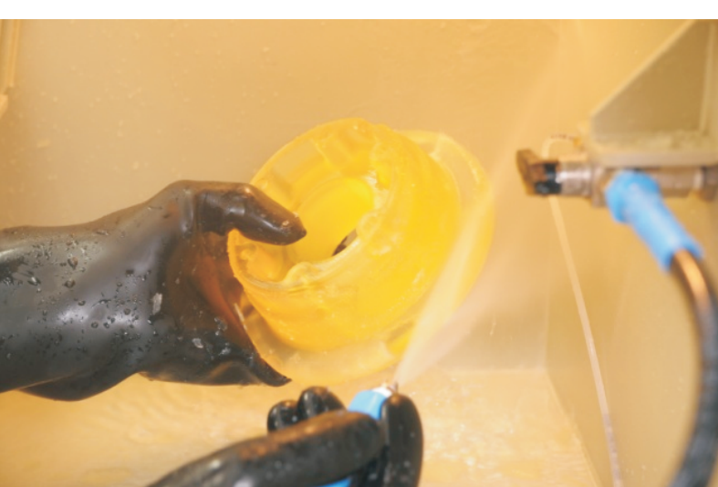
Rys. 2.10. Wypłukiwanie materiału podporowego przy użyciu dyszy: a) grubej, b) cienkiej
