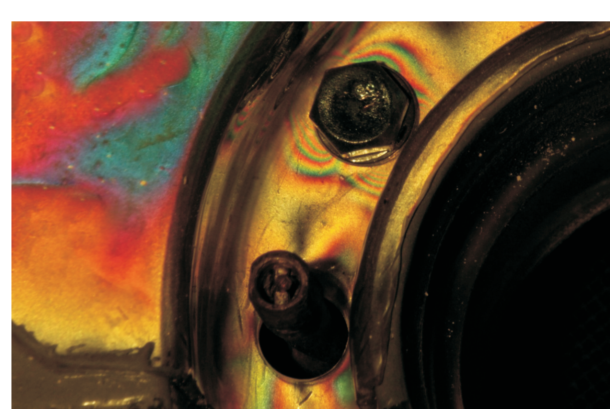
Dodatkowe izochromy można również zaobserwować w okolicy otworu na wentyl (Rys. 3.1.7.).
