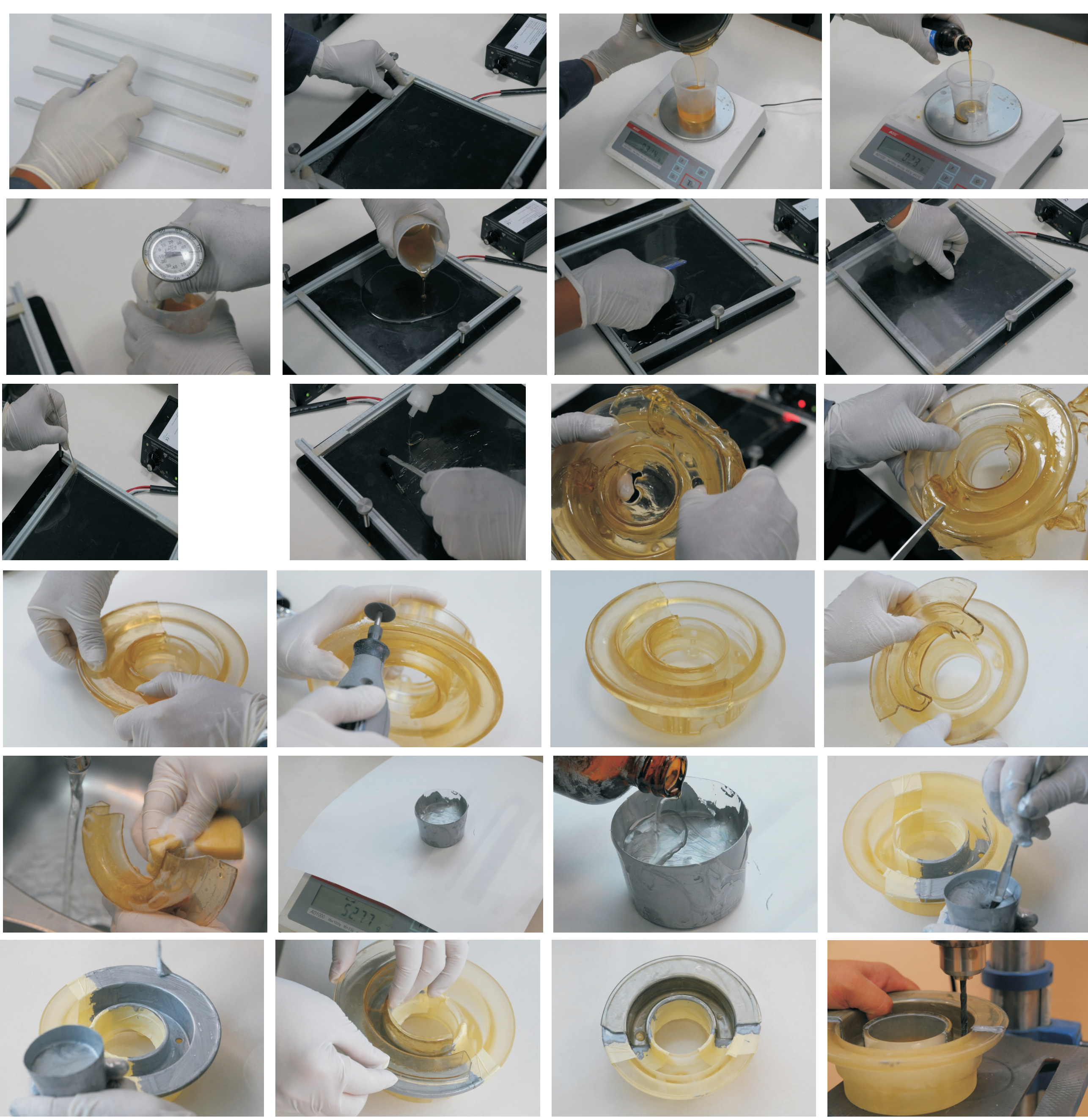
Kolejne etapy wykonania powłoki i badania rozkładu naprężeń w modelu piasty koła samolotu przy wymuszonym obciążeniu.
