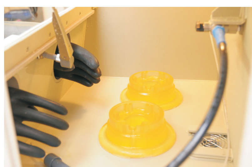
Rys. 2.9. Modele piasty koła samolotu w komorze ciśnieniowej myjki wodnej
