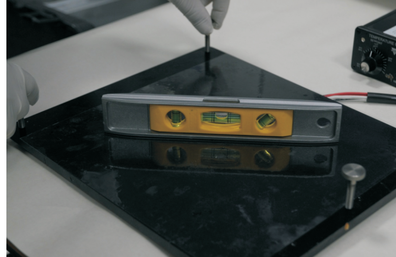
Nalożenie podkładu foliowego oraz usunięcie spod niego pęcherzy powietrza w celu uzyskania jednakowej grubości powłoki optycznie czynnej
