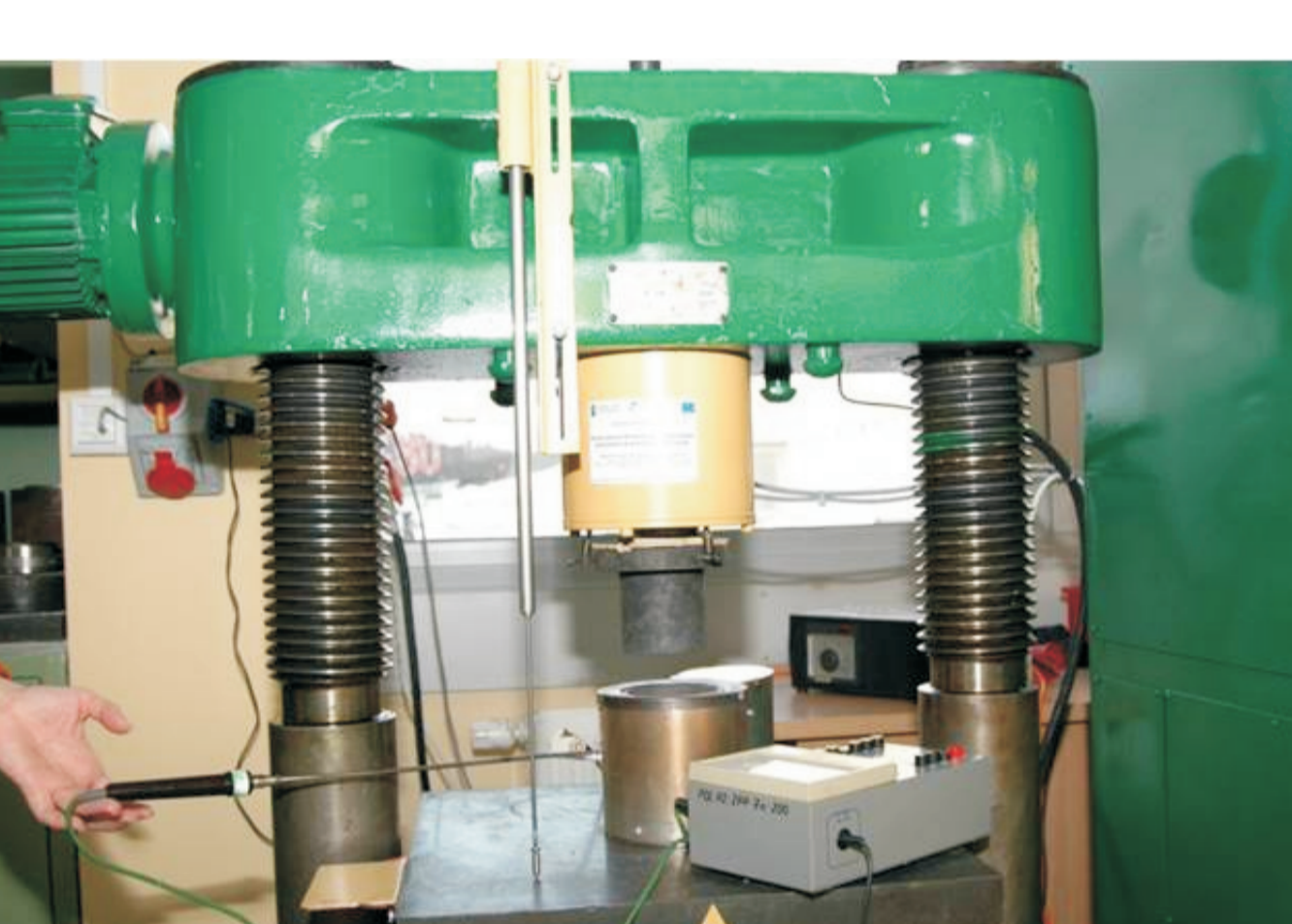
Komora grzewcza z regulacją temperatury
