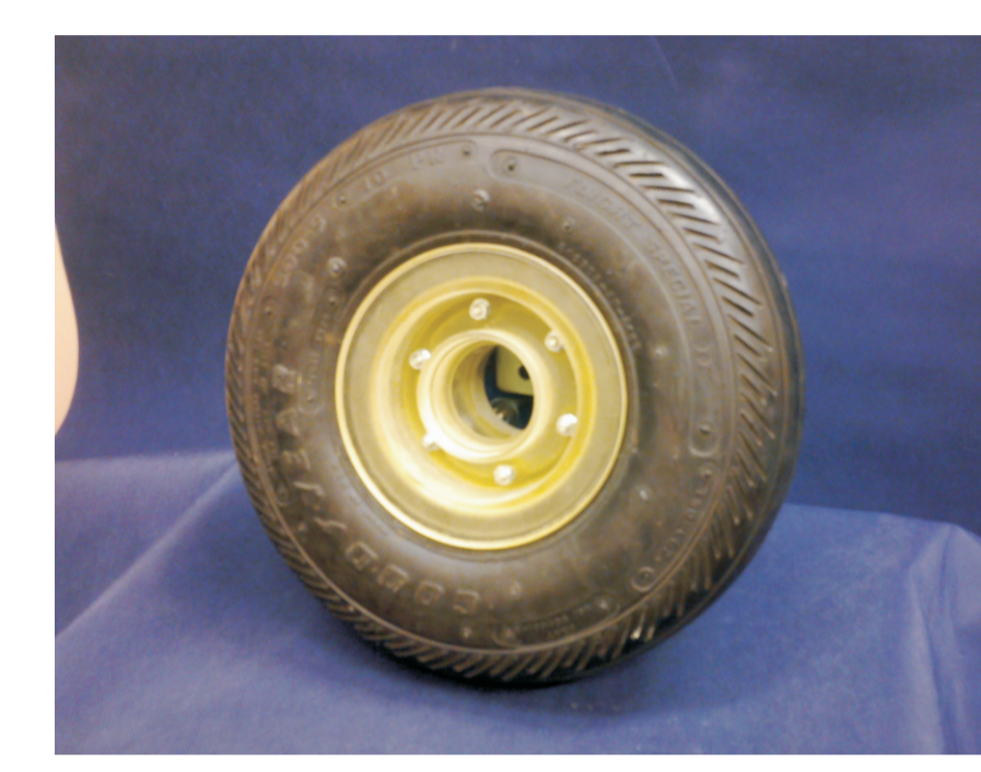
Koło 5.00-5 do samolotów lekkich wykonane w technologii Rapid Prototyping
