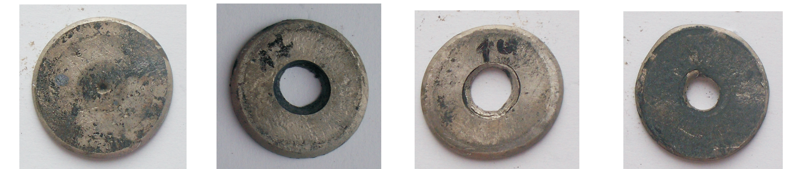
Rys. 1. Przykładowe próbki ze stopu magnezu MA2 nagrzane do temperatury 450°C i spęczone (od lewej) bez smarowania, ze smarowaniem dwusiarczkiem molibdenu, ze smarowaniem łożem z grafitem, ze smarowaniem akwagrafitem.
