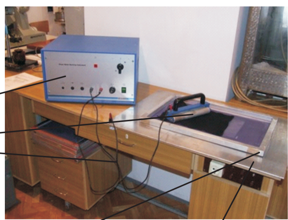
Rys. 3. Widok stanowiska do nanoszenia siatek pomiarowych: 1 - zespół zasilający, 2 - walek do nanoszenia siatek, 3 - przewody przyłączeniowe, 4 - wzorzec siatki, 5 - materiał - blacha, na którą nanoszono siatki
