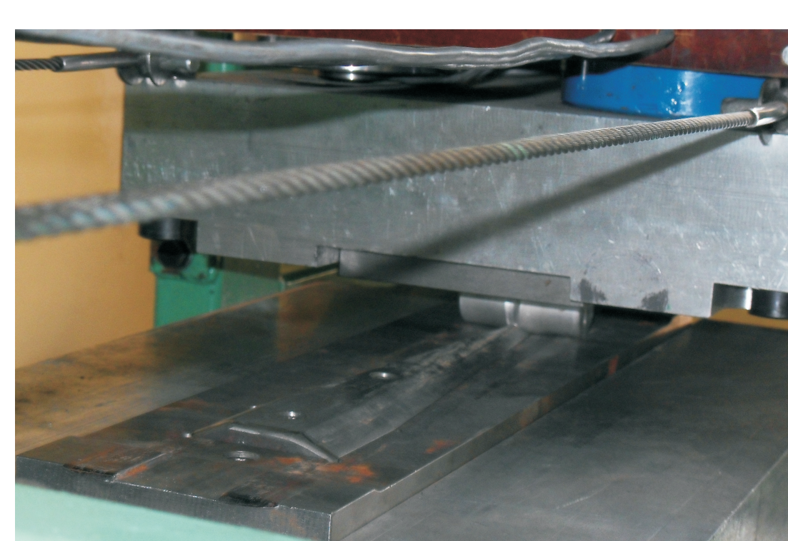
Rys. 3. Początek procesu WPK odłuki ze stopu PA38 (faza wcinania narzędzia)
