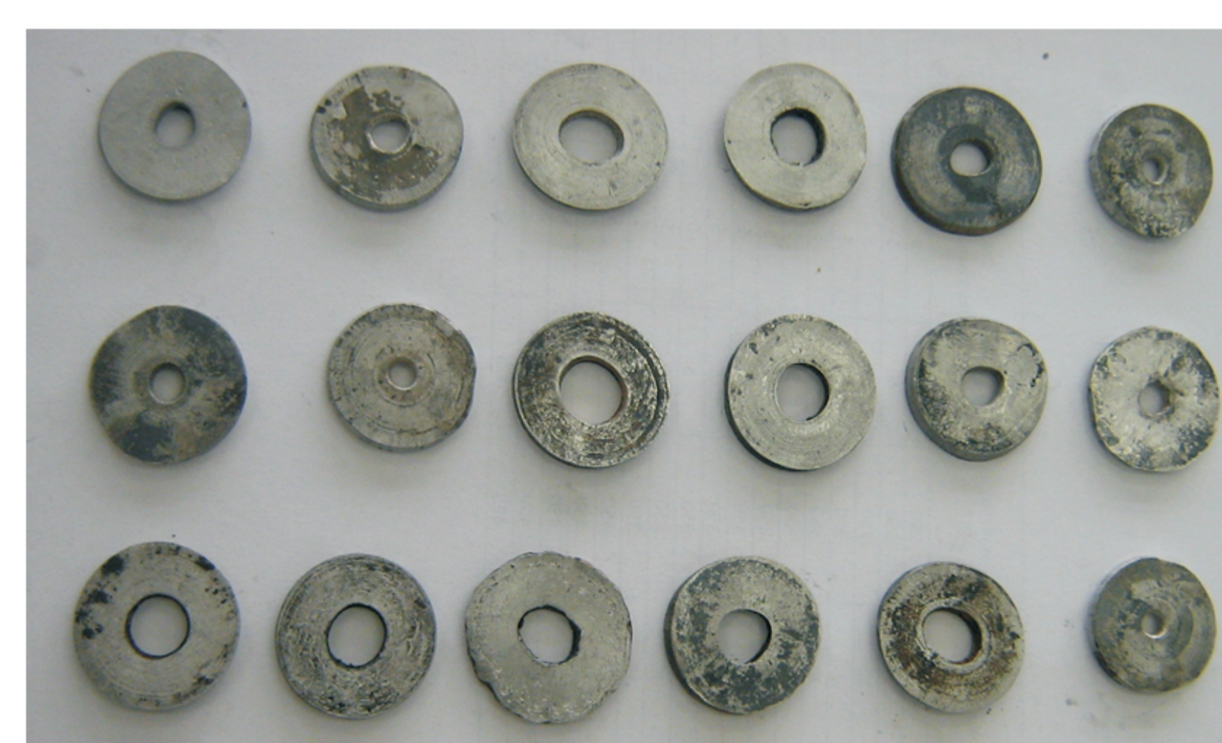
Rys. 2. Spieczone próbki ze stopu aluminium PA38 (6101A)
