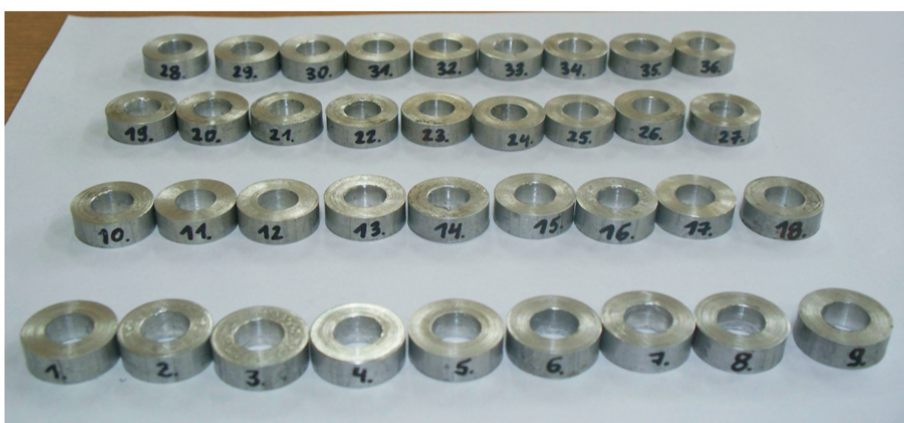
Rys. 1. Próbkę pierścieniową ze stopu aluminium PA38 (6101A) przygotowaną do badań warunków tarcia
