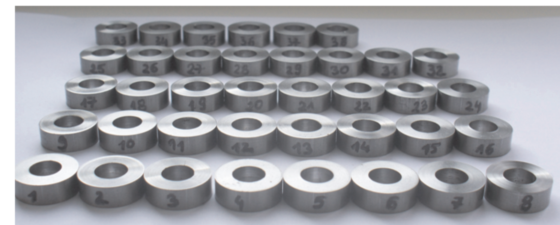
Rys. 1. Próbkę pierścieniową ze stopu tytanu Ti6Al4V przygotowaną do badań warunków tarcia
