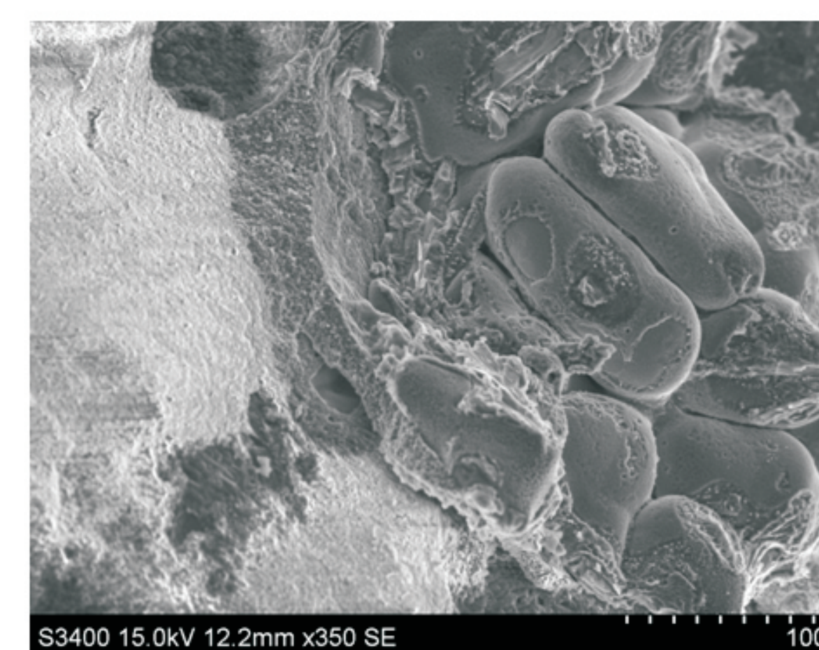
Rys. 4. Przełom kompozytu AlMg5/Al 2 O 3 o strukturze infiltrowanej
