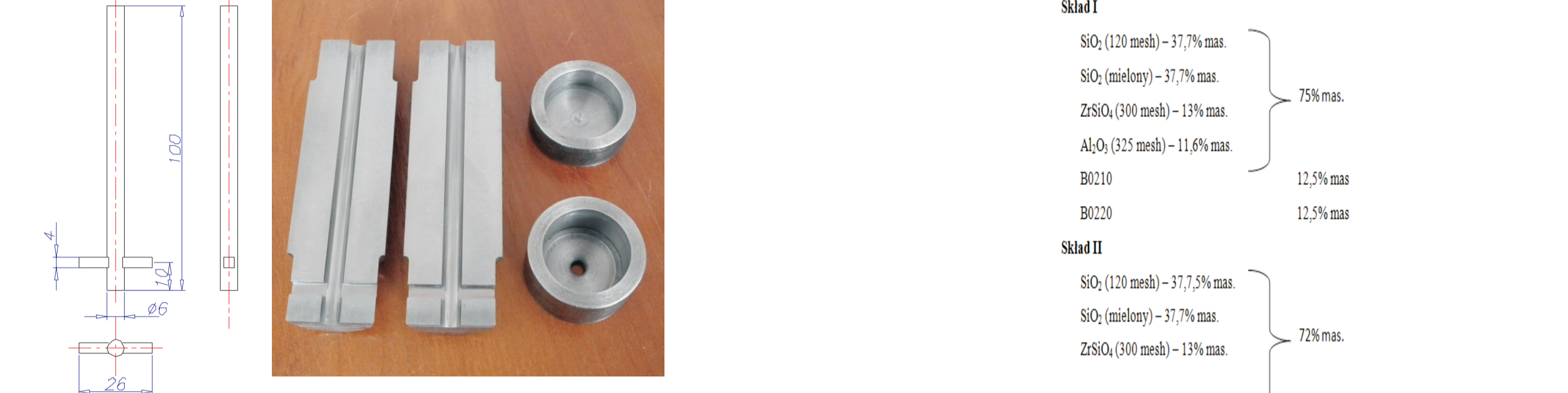
Rys. 1. Schemat rdzenia ceramicznego oraz forma przeznaczona
