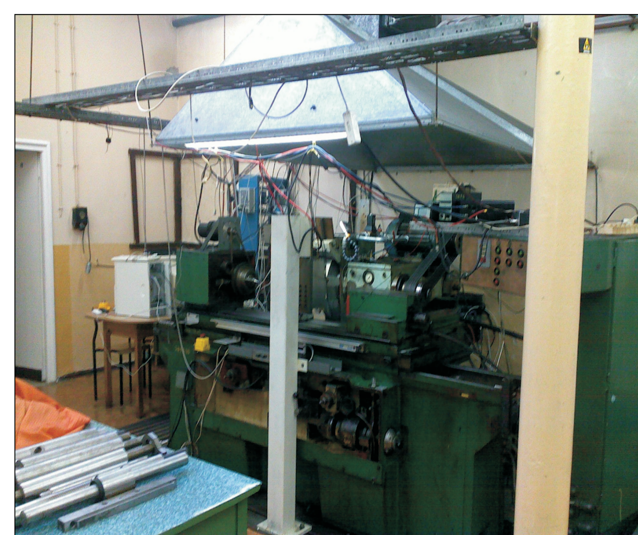
Stanowisko zapewnia pomiar sił szlifowania, drgań, emisji akustycznej, wymiaru i kształtu przedmiotu
