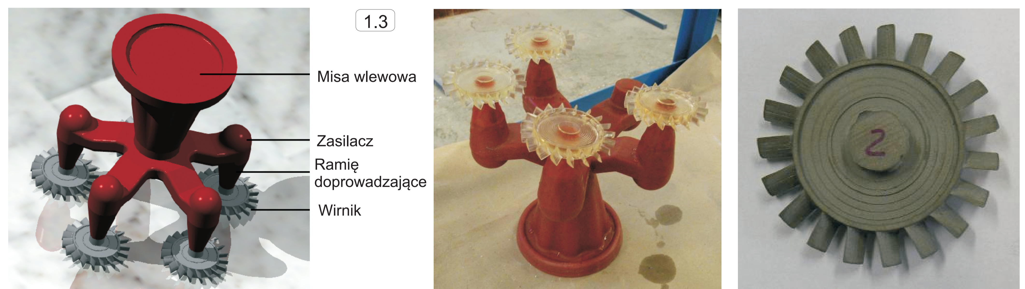
1.3 Model CAD wirnika turbiny μSO-1 wykonany w Unigraphics Nx 4)
