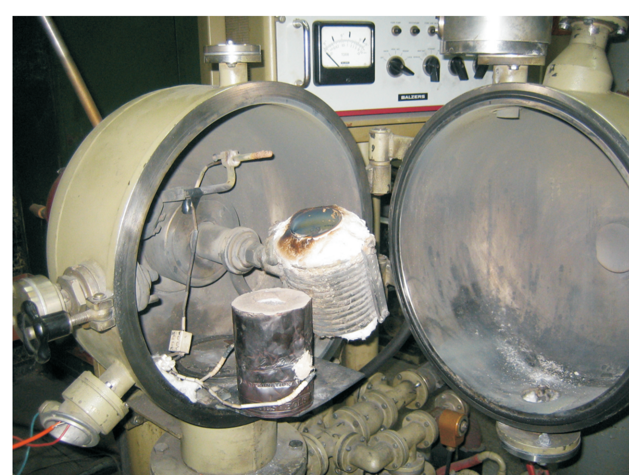
Schemat stanowiska badawczego: 1 – komora pieca VSG-02; 2 – tygiel i cewka indukcyjna; 3 – grafitowa forma odlewnicza; 4 – Aparat Crystallograph PC-8T; 5 – cyfrowy miernik temperatury; 6 – komputer PC; 7 – przewód kompensacyjny; 8 – drukarka
