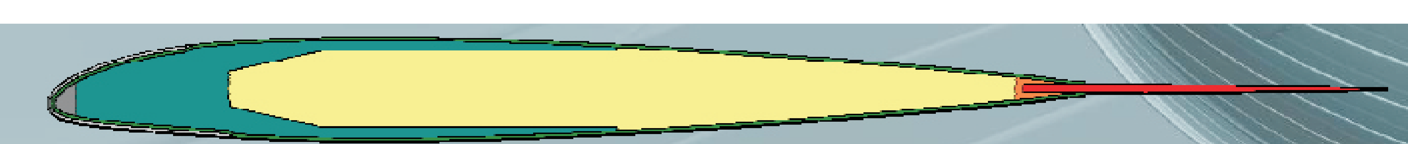
Rys.10. Konstrukcja łopaty z aktywnie sterowanym trymerem.
