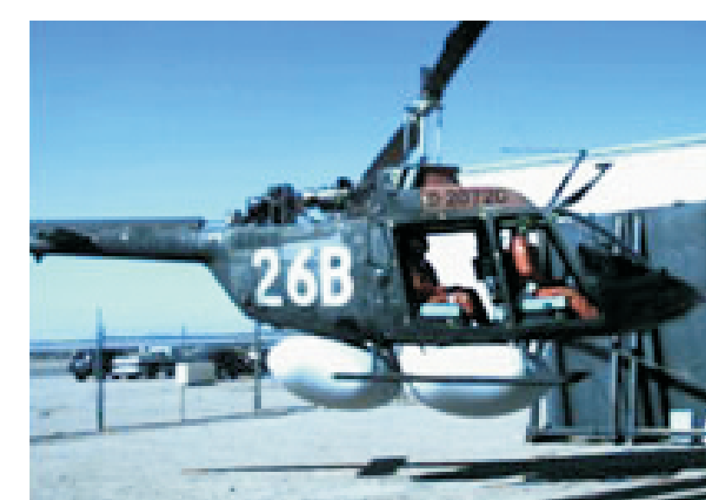
Zastosowanie zewnętrznej poduszki w helikopterze wojskowym (Rafael)
