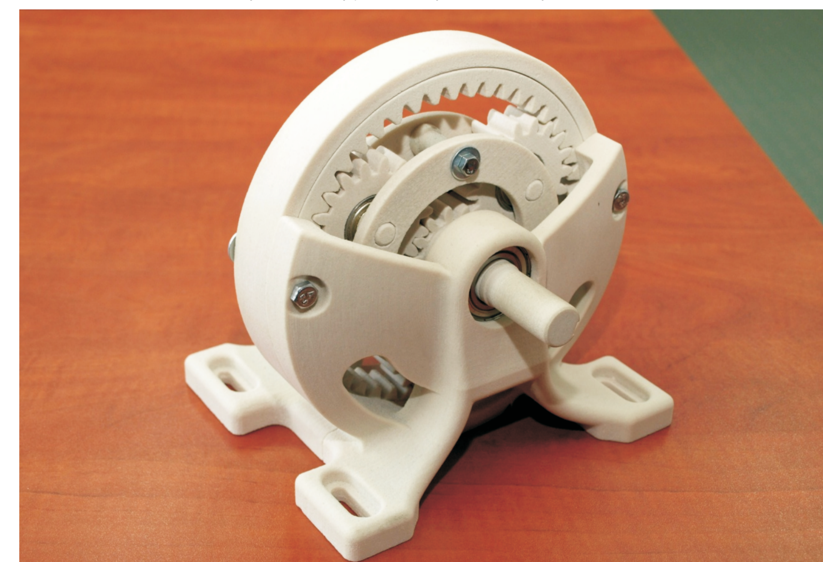
Rys. 8. Model przekładni wykonany metodą 3DP
