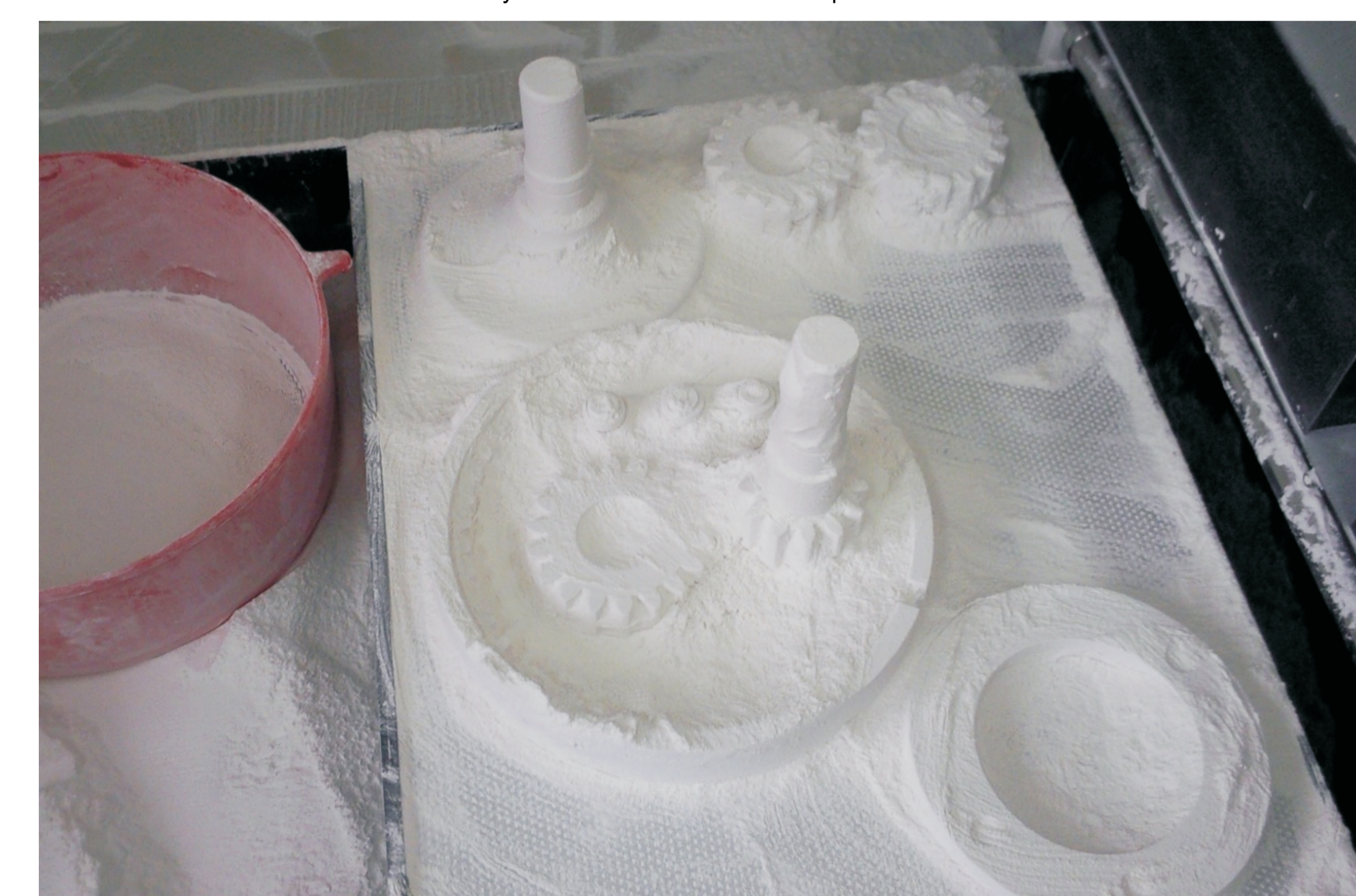
Rys. 7. Elementy przekładni wykonane metodą 3DP
