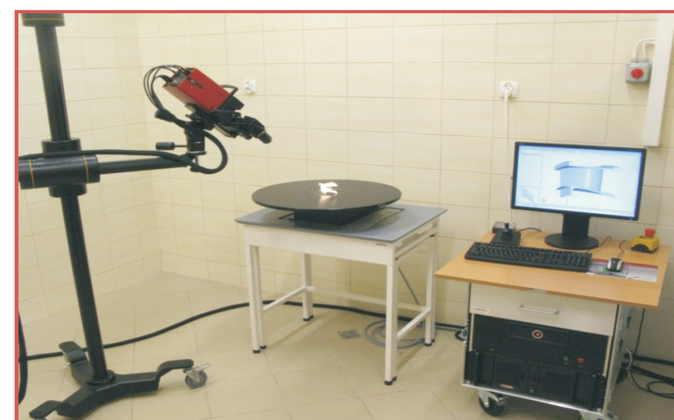
Skaner 3D do pomiaru grubości powłok TBC metodą nieniszczącą 3D scanner for measuring coating thickness TBC by non-destructive method
