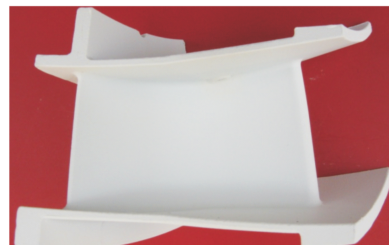
Łopátka kierująca turbin silnika lotniczego z powłokową barierą ceramiczną wytworzoną metodą EB-PVD oraz modyfikowaną platyną międzywarstwą Turbine vane of aircraft engine with a ceramic barrier coating prepared by EB-PVD and modified platinum bondcoat
