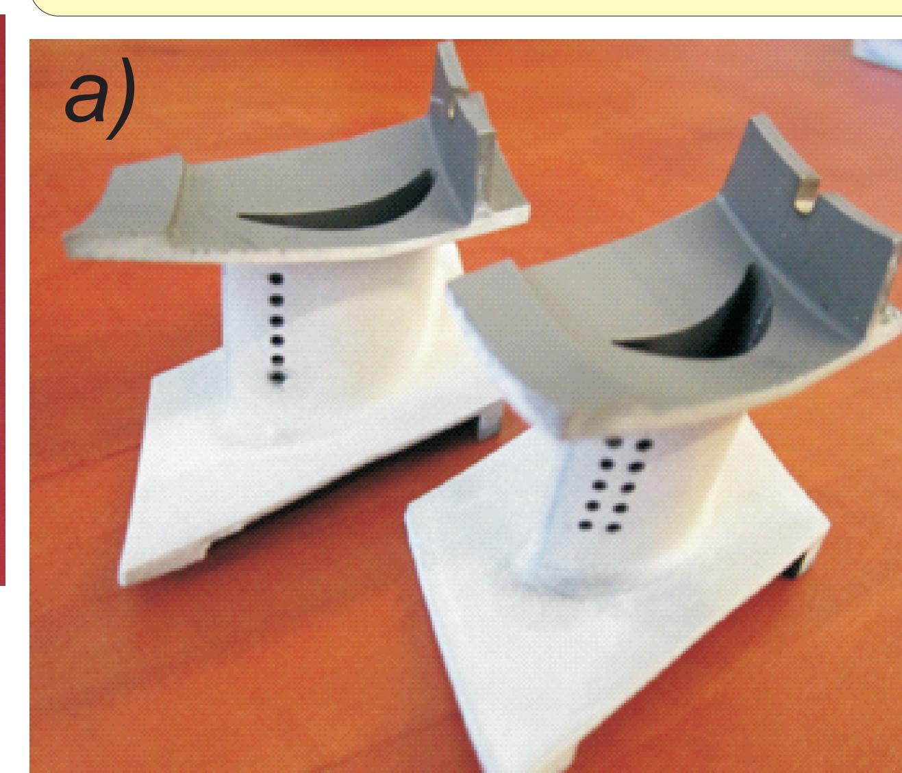
Łopátka turbin silnika turbodrzutowego śmigłowca a) oraz turbinowego samolotu b) po procesie natryskiwania warstwy TBC za pomocą systemu TRIPLEX PRO 200 oraz drążenia laserowego Turbojet engine turbine blade of a helicopter a), and the turbine blade of aircraft b) coating after the thermal spraying process by TRIPLEX PRO 200 and the laser drill
