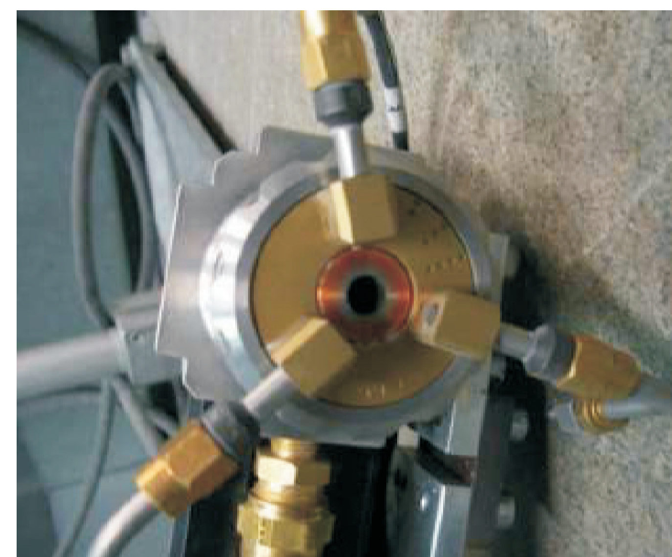
Trójelektrodowy system TRIPLEX PRO 200 Triple electrode TRIPLEX PRO 200 system
