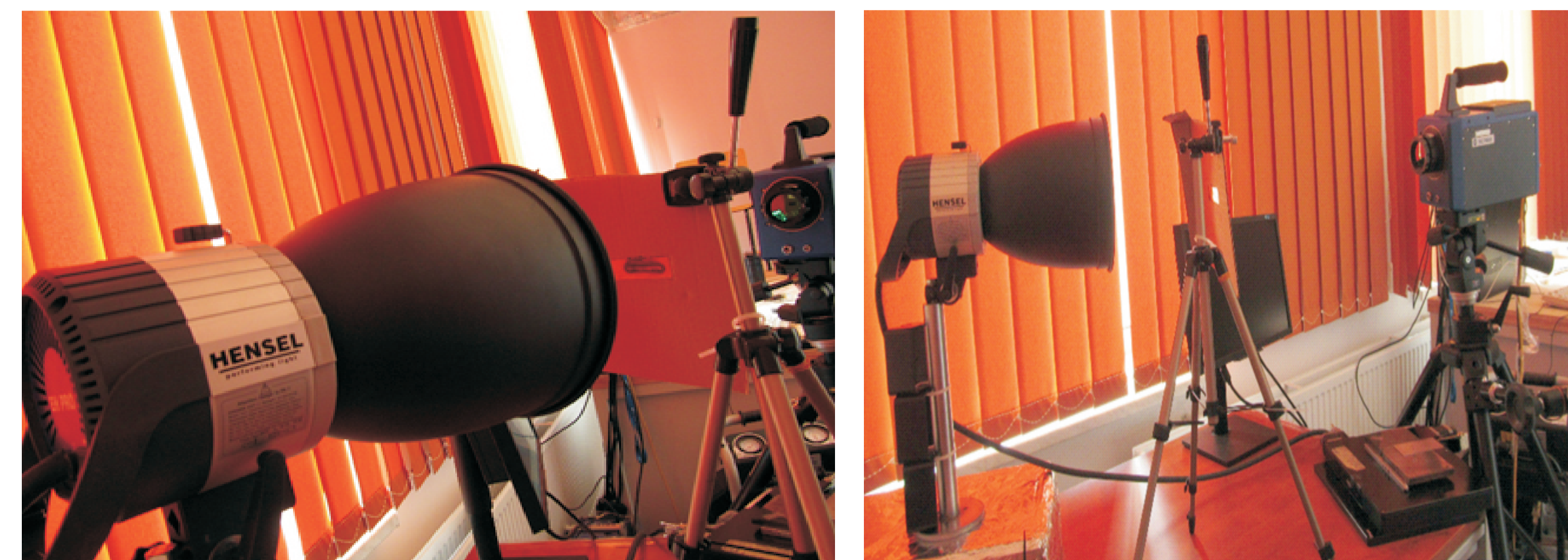
Rys. 10. Stanowisko badawcze do wykrywania nieciągłości metodą termograficzną. Fig. 10. Measuring installation for detecting discontinuities by thermographic method.
