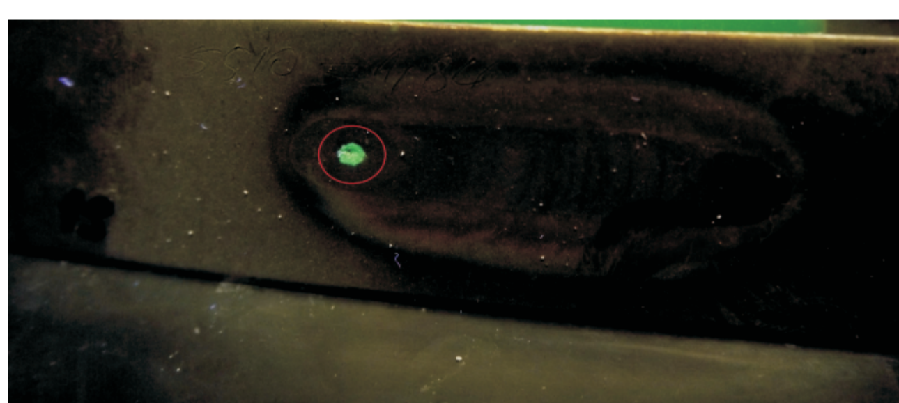
Rys. 5. Próbkę nr 19 z warstwą napawaną wykonaną ze stali nierdzewnej 321. Fig. 5. Welding layer sample no. 19 made of stainless steel 321
