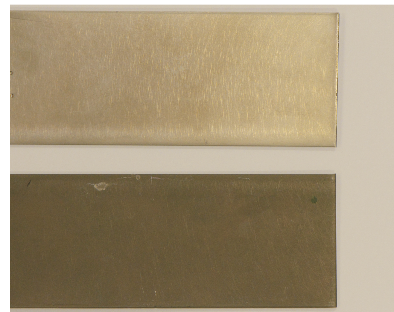
Rys. 1. Powierzchnia stali AMS5510 po wyżarzeniu w piecu z molibdenową komorą grzejną (u góry zdjęcia); po wyżarzeniu w piecu z grafitową komorą grzejną (u dołu zdjęcia) Fig. 1. The surface of AMS5510 steel after annealing in a furnace with a molybdenum heating chamber (top image); after annealing in a furnace with a graphite heating chamber (bottom image)
