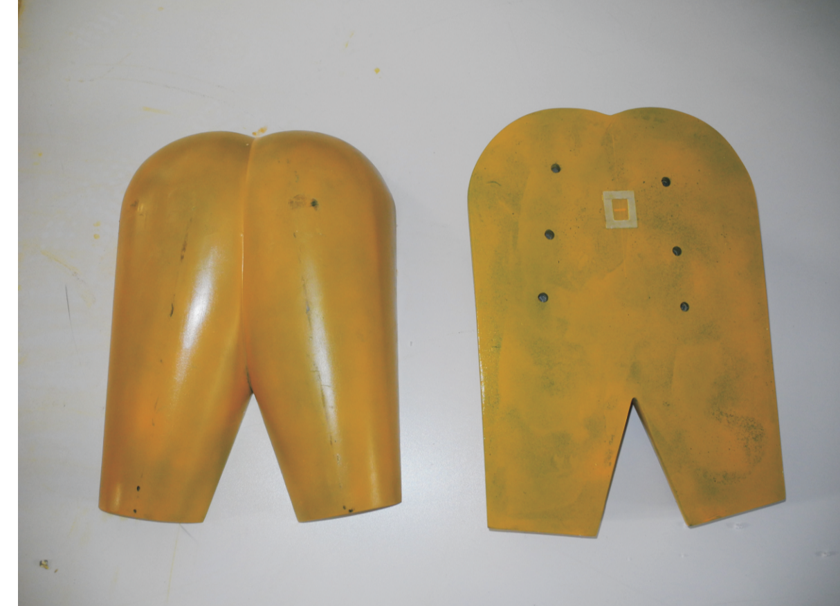
Rys. 14. Anatomiczny wgnębnik zgodnie z normą Fig. 14. Anatomical human indenter from standard
