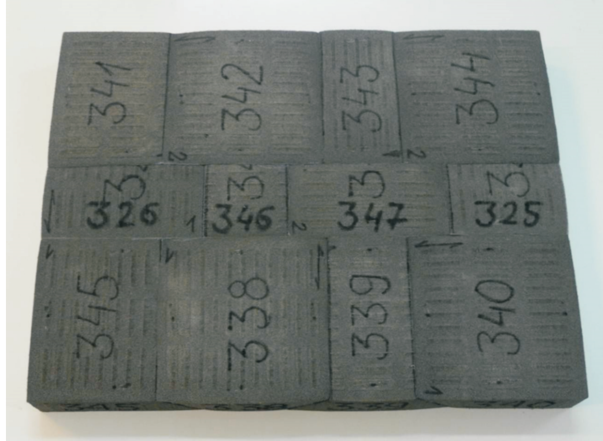
Rys. 12. Warstwa auksetyczna utworzona z 12 kształtek Fig. 12. Auxetic layer composed of 12 foam specimens
