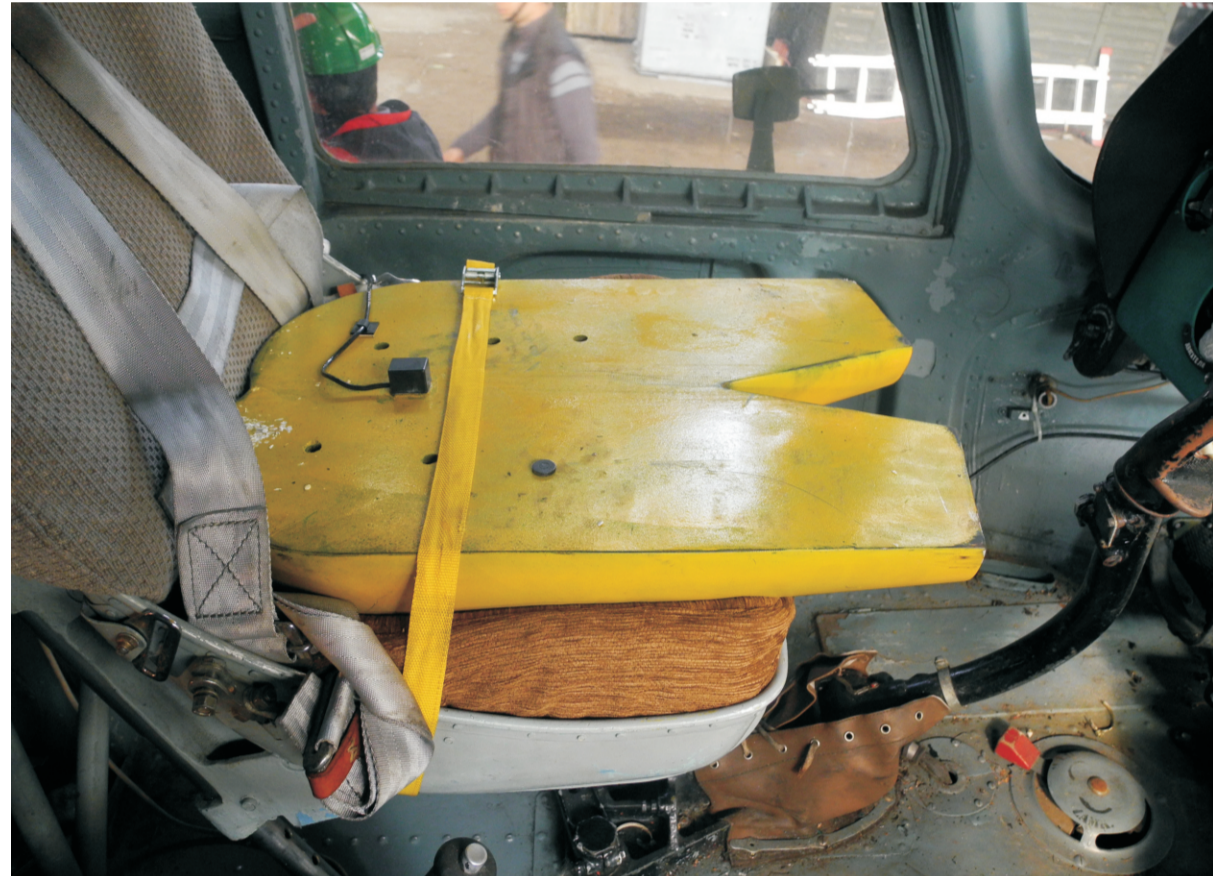
Rys. 15. Wgnębnik zainstalowany na siedzisku pilota Fig. 15. Indenter installed in the pilot seat
