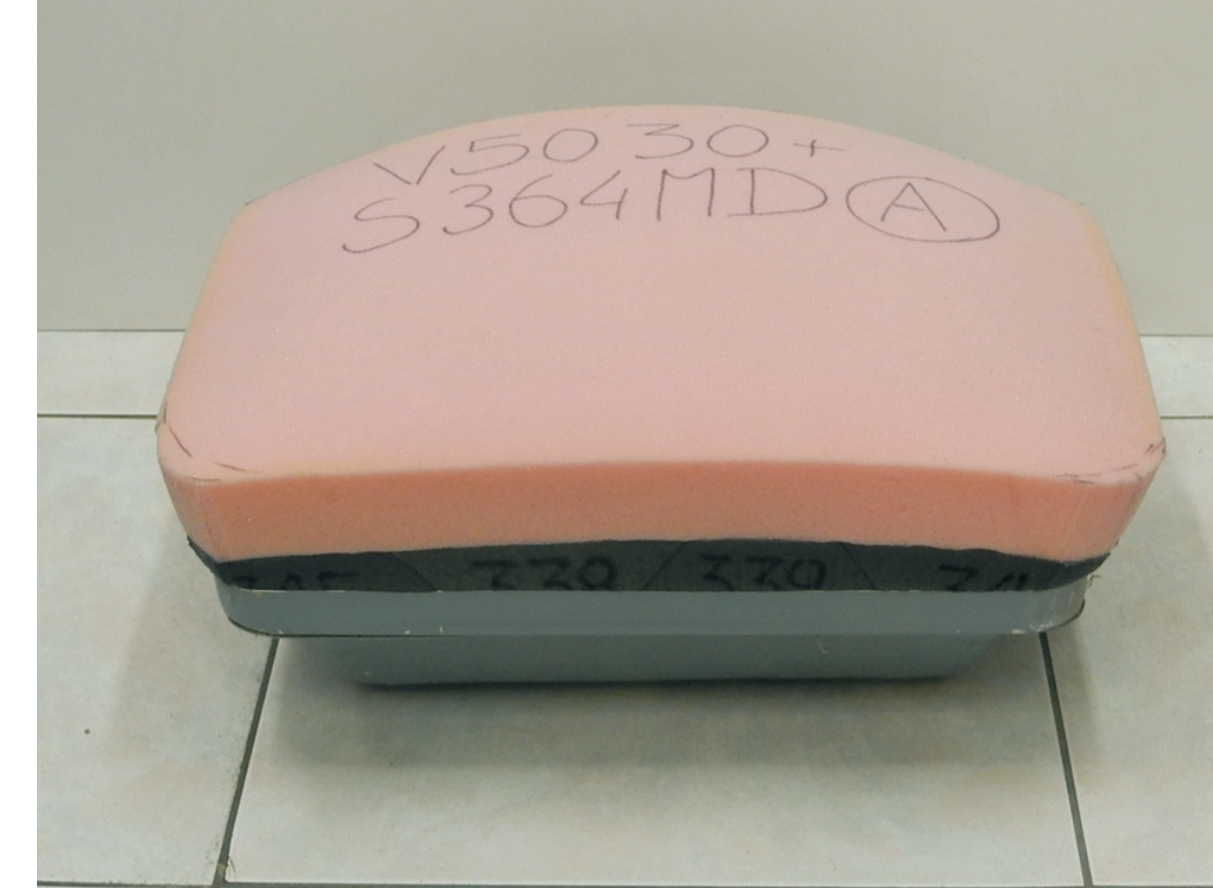
Rys. 13. Gotowy wkład z górną warstwą wiskoelastyczną Fig. 13. Complete cushion with top viscoelastic layer
