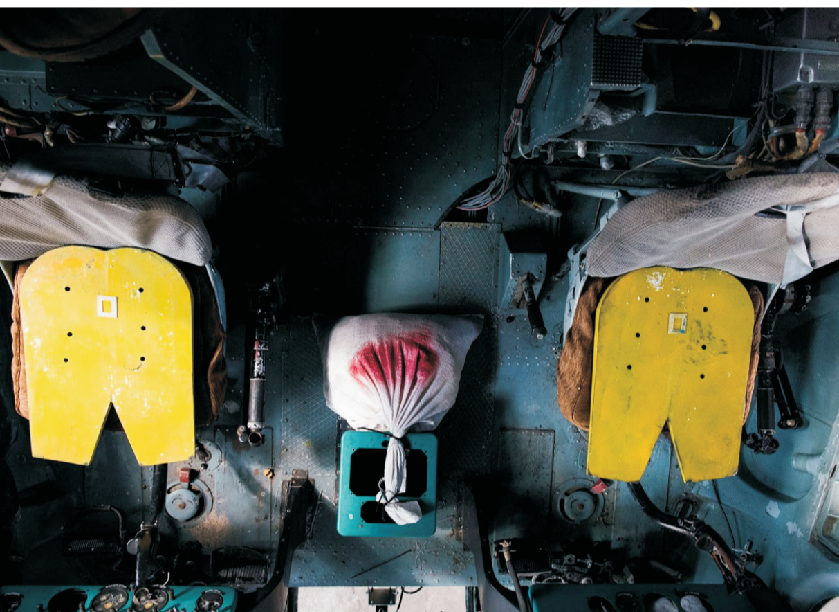
Rys. 17. Wgnębniki zamontowane na fotelach pilotów Fig. 17. Indenters installed on the pilot seats
