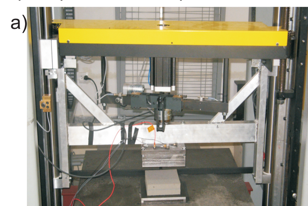
Rys. 3: Próby uderzeniowe pianek poliuretanowych: a) widok ogólny stanowiska b) przykładowe wyniki pomiaru Fig. 3: Impact testing of the polyurethane foams: a) general view of testing stand b) exemplary results
