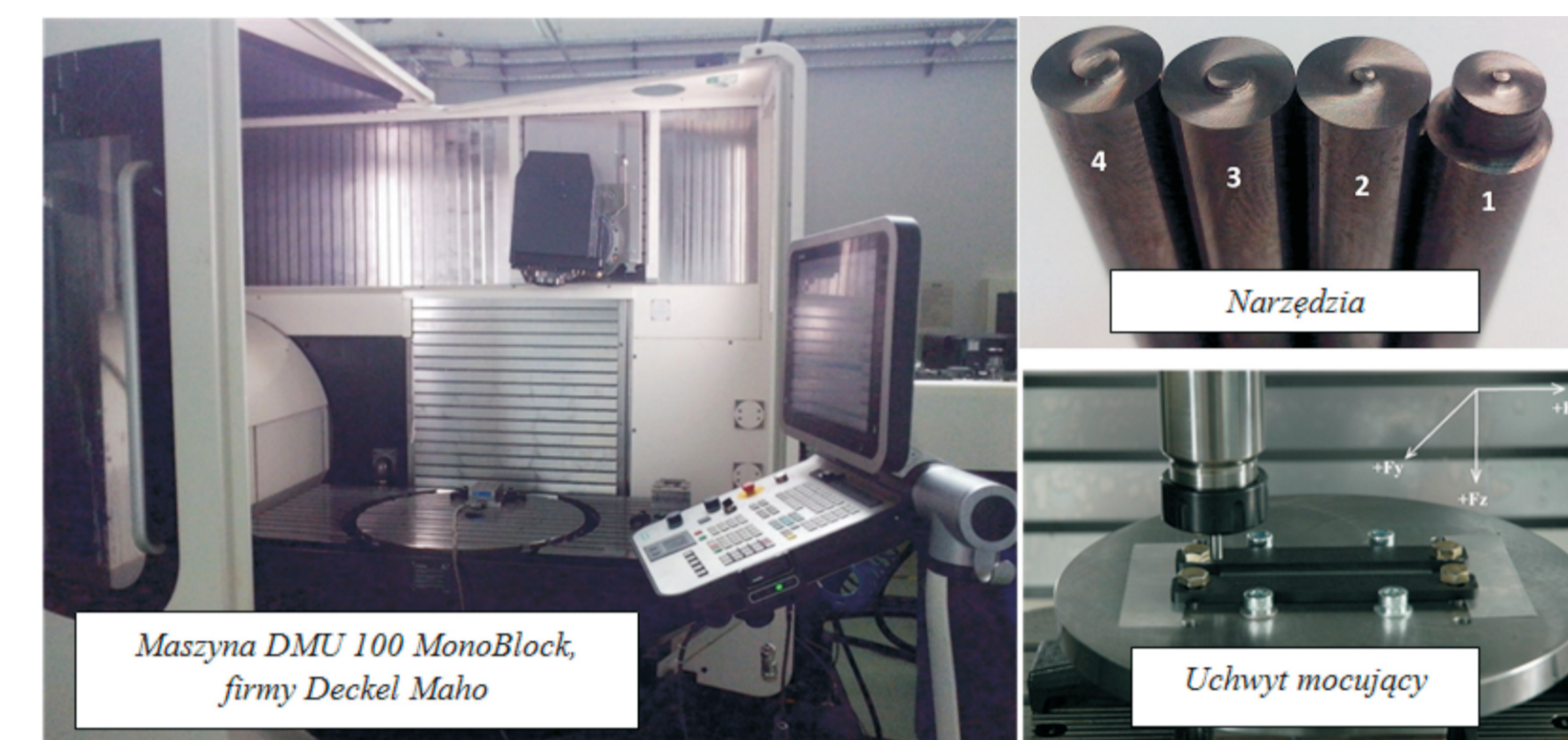
Stworzenie stanowiska do wykonywania złączy FSW blach cienkich i narzędzia stosowane w badaniach Friction stir welding set-up of joining thin sheets and tools used in the tests
