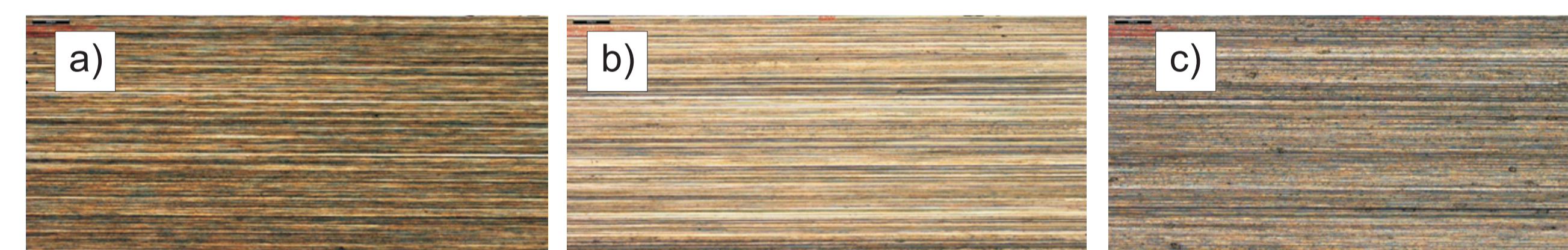
Rys.9. Widok powierzchni po szlifowaniu CFG z użyciem ściernic: a) 1, b) 2, c) 3
