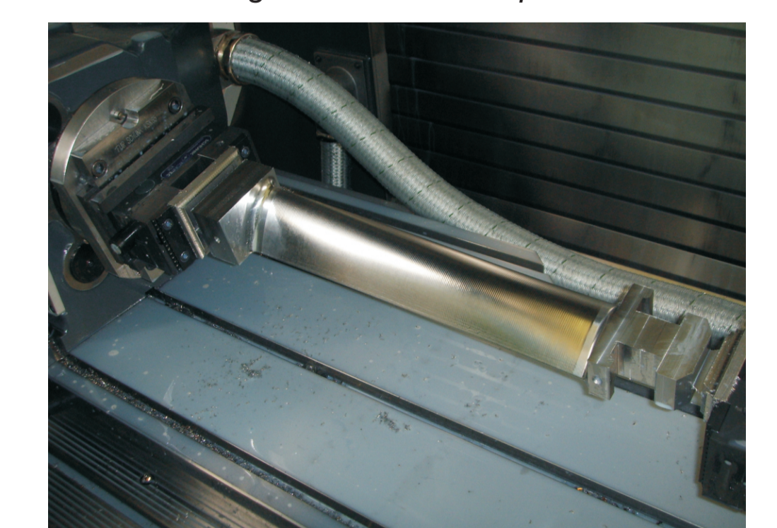
Rys.11. Gotowa część łopalki Fig.11. Finished turbine blade
