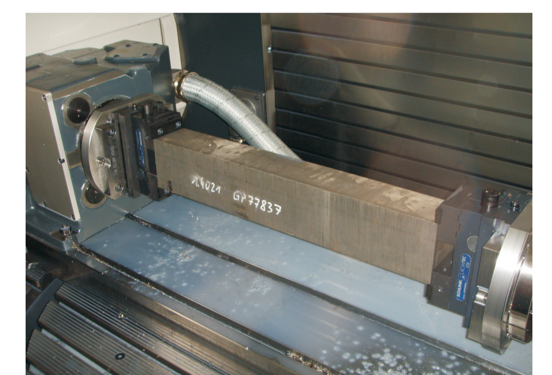
Rys.10. Polfabrykat w postaci prostopadościanu Fig.10. Cubical raw part
