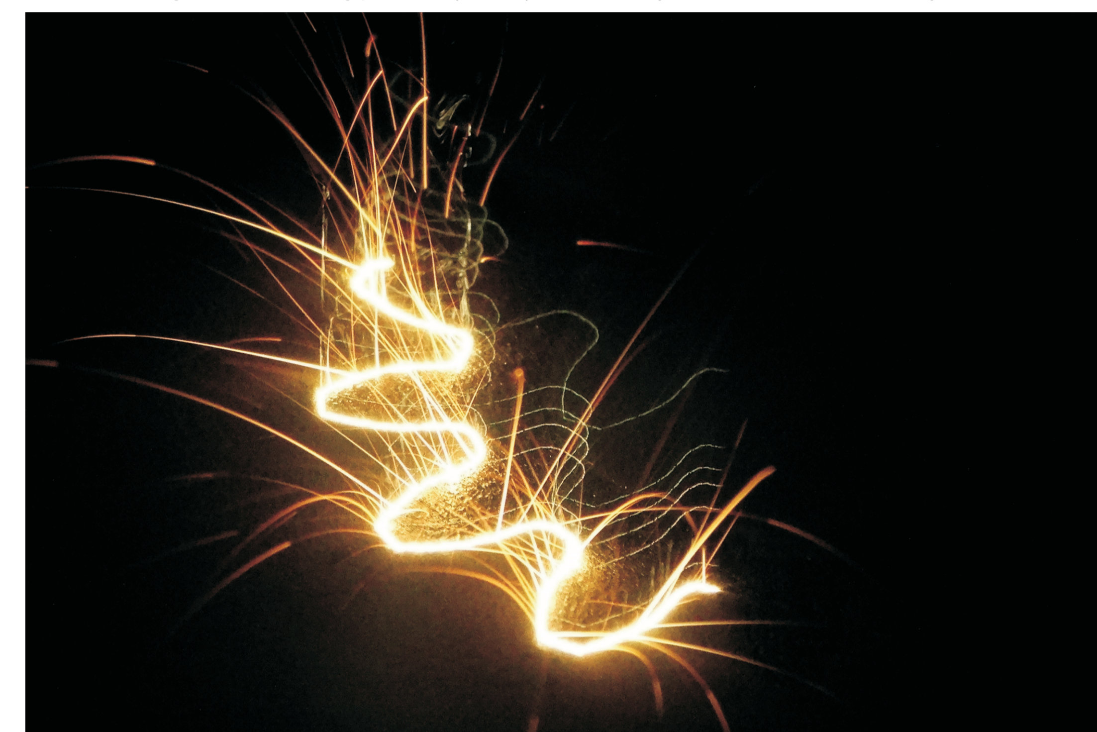
Rys. 8. Proces spiekania proszku ze stopu GP1 na obrysie modelu Fig. 8. The sintering process of GP1 alloy powder on the contour model
