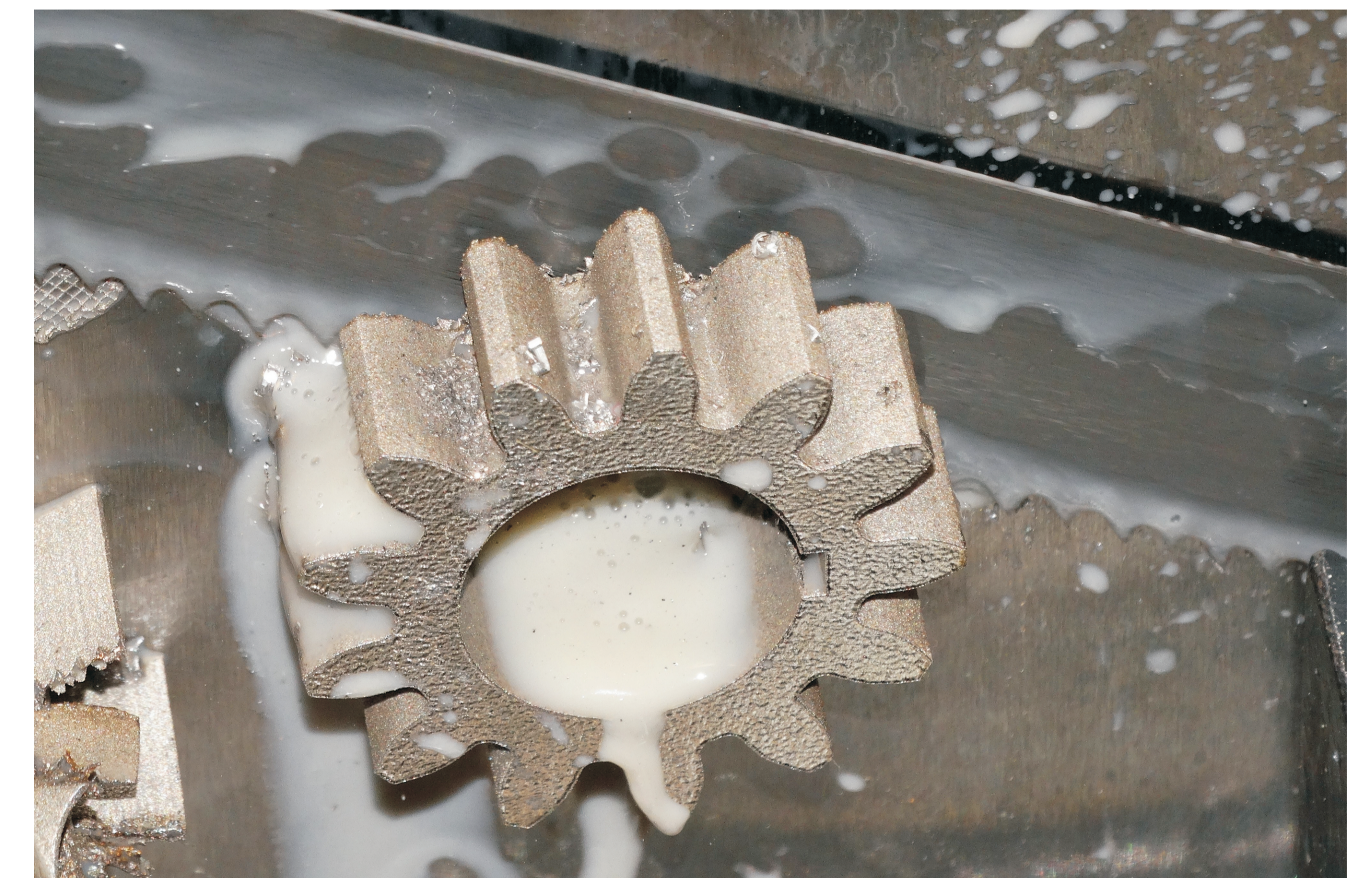
Rys. 12. Proces odcinania modeli kół zębatych od platformy roboczej Fig. 12. Cutting off process of gear models from the working platform
