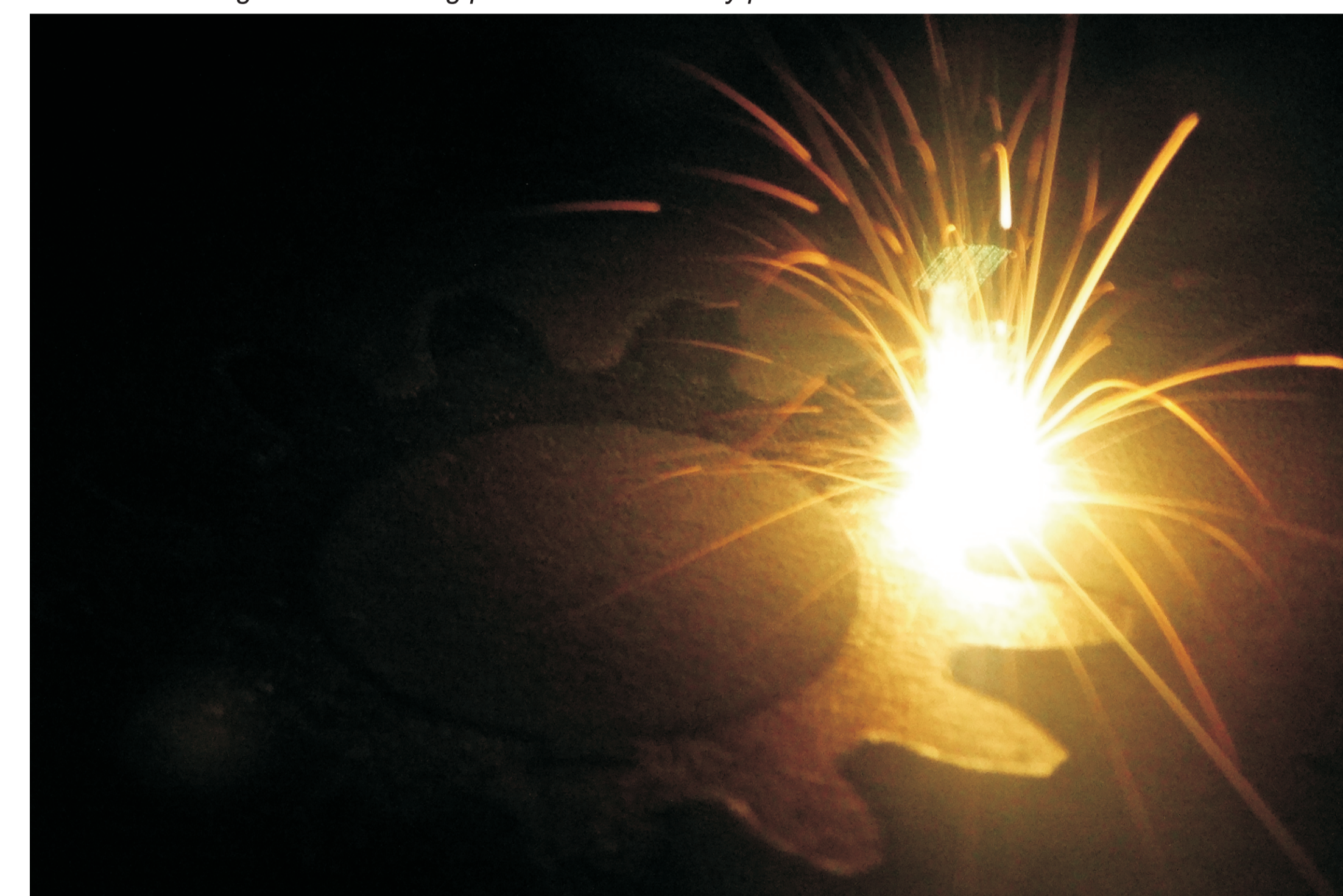
Rys. 9. Proces spiekania proszku ze stopu GP1 wewnątrz warstwy modelu - wypełnianie Fig. 9. The sintering process of GP1 alloy powder within the model layer - filling
