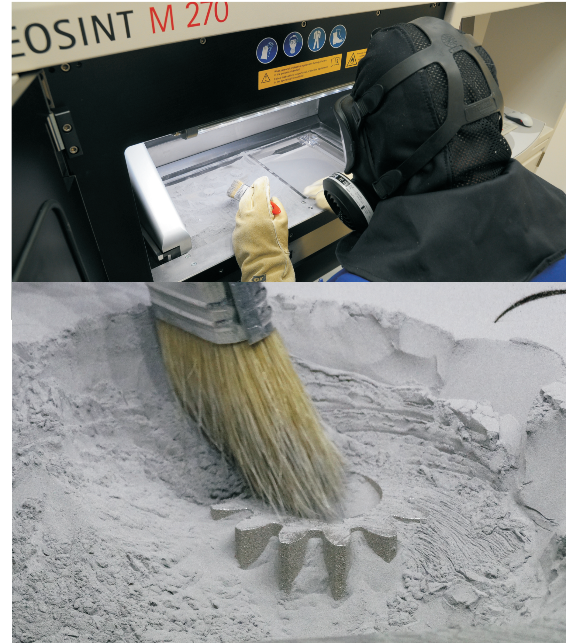
Rys. 10. Czyszczenie modeli DMLS bezpośrednio po procesie z pozostałego proszku stali nierdzewnej Fig. 10. Cleanup DMLS models immediately after the process of other stainless steel powder
