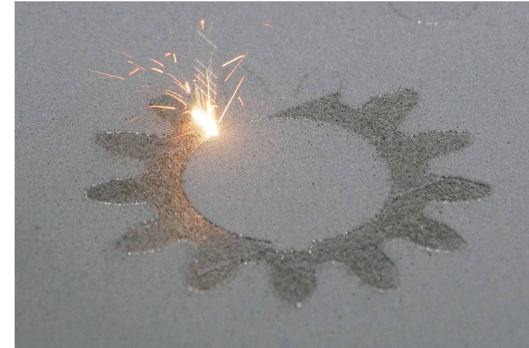
Rys. 7. Proces spiekania (DMLS) warstw modelu z proszku ze stopu stali nierdzewnej Fig. 7. The sintering process (DMLS) of model layers of stainless steel alloy
