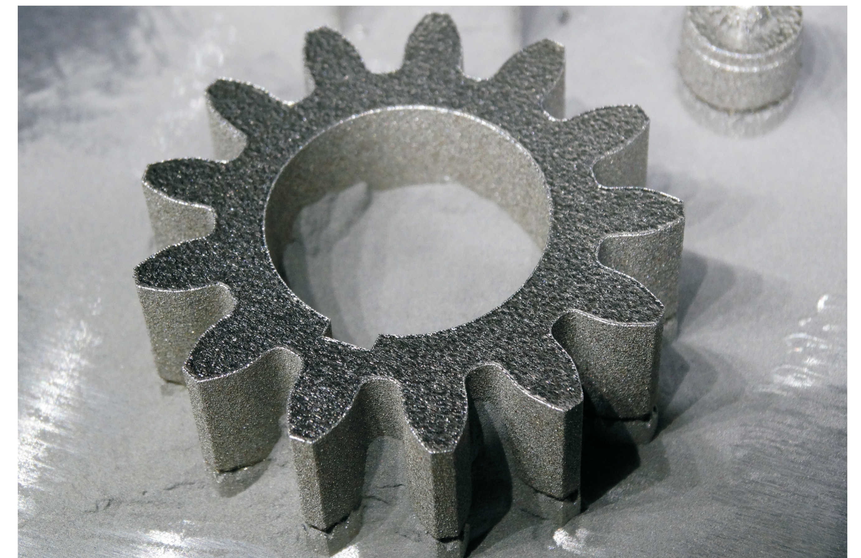
Rys. 11. Koło zębate DMLS bezpośrednio po zakończonym procesie na platformie roboczej (wraz ze strukturą podpierającą) Fig. 11. DMLS gear model immediately after the completion of the process on the working platform (including support)
