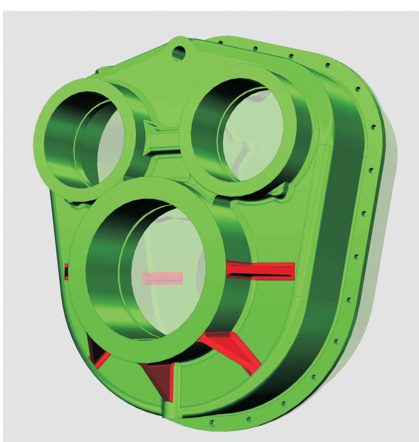
Rys. 5. Kadłub górny - wersja geometryczna E - wzmacnienie kadłuba na zewnątrz - łożysko F Fig. 5. Upper housing - geometrical version E - external reinforcement of the housing - bearing F
