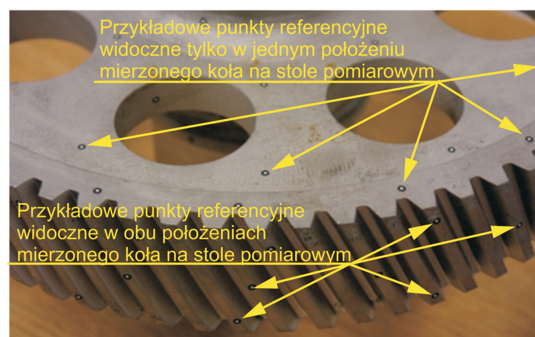
Rys. 11. Koło zębate z punktami referencyjnymi widocznymi w obu seriach pomiarowych Fig. 11. The gear reference points visible in both series of measurement
