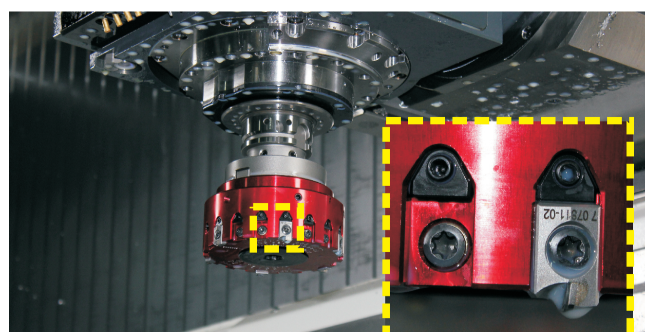
Rys. 2. Frez z wkładkami z PKD wykorzystany do testów Fig. 2. Diamond milling cutter used for testing
