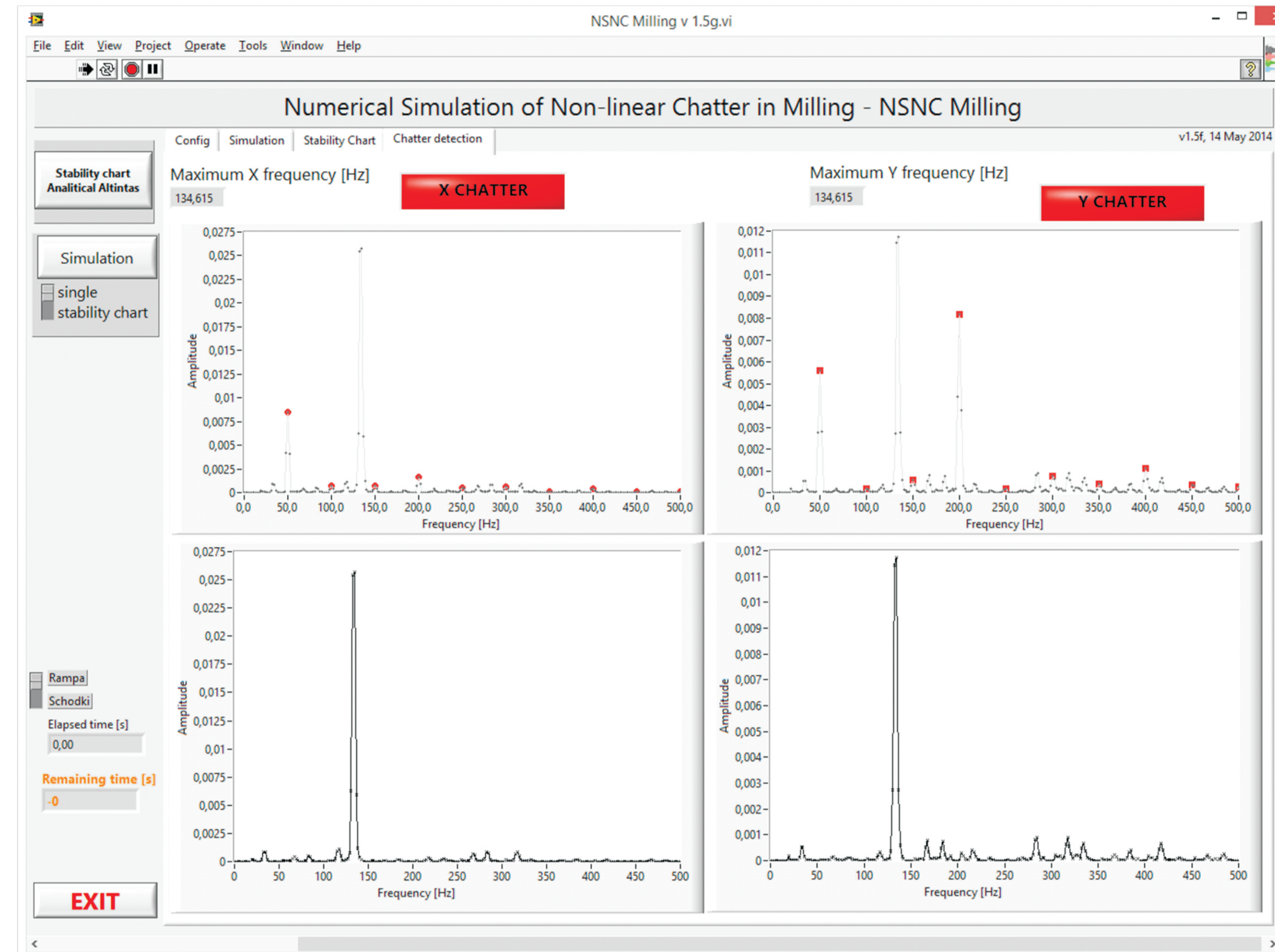
Rys.4. Widmowe wykrywanie drgań – stan niestabilny Fig.4. Chatter detection in single simulation - unstable
