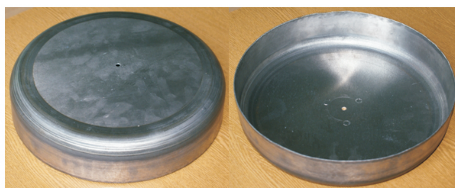
Półwyrobek pokrywy po wyoblaniu (stop AZ31) Semi-finished product of the bonnet after spinning (AZ31 alloy)
