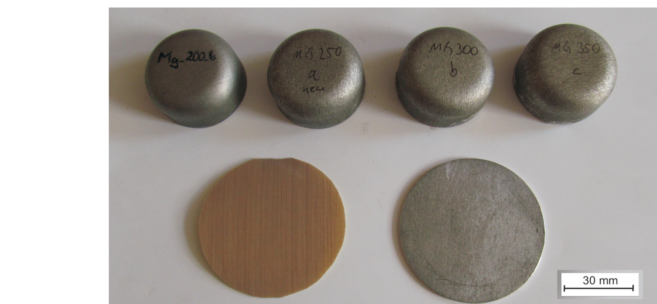
Rys. 4. Przykłady wytłoczek wykonanych ze stopu AZ31 Fig.4. Samples of stamping developed from AZ31 alloy
