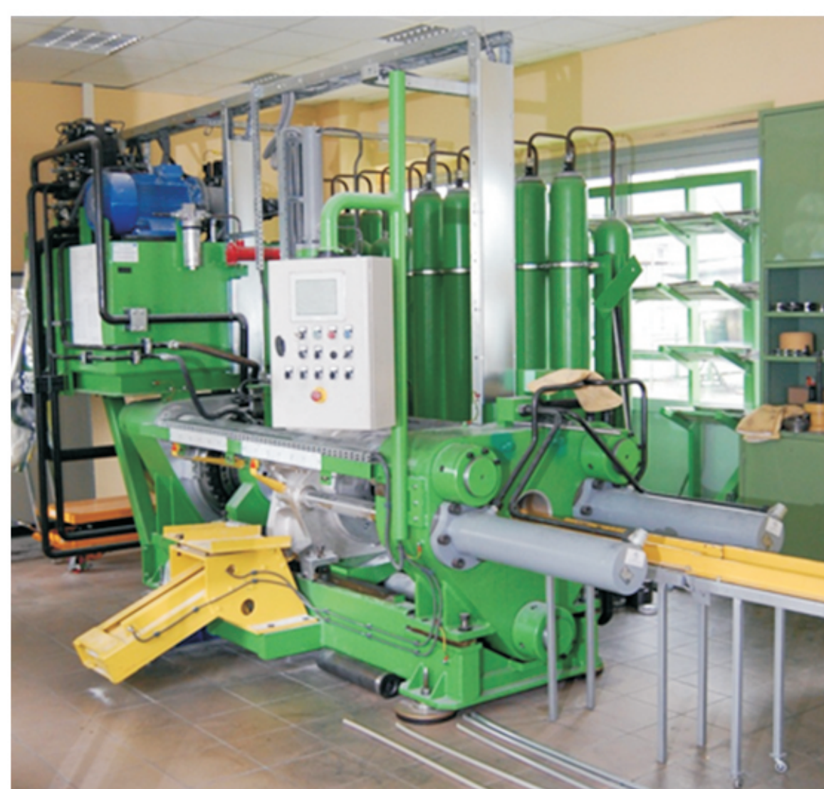
Rys. 3. Hydrauliczna prasa pozioma 5MN do wyciskania przeciwnieżywno, wymiary wlewa oraz parametry procesu wyciskania.
