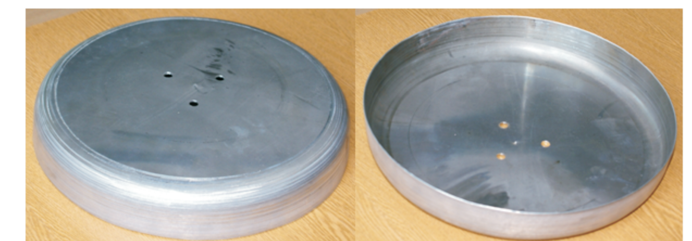
Półwyrob pokrywy helikoptera po wyoblaniu (stop 2024, wymiary pokrywy: średnica d = 284 mm, wysokość h = 42 mm)
