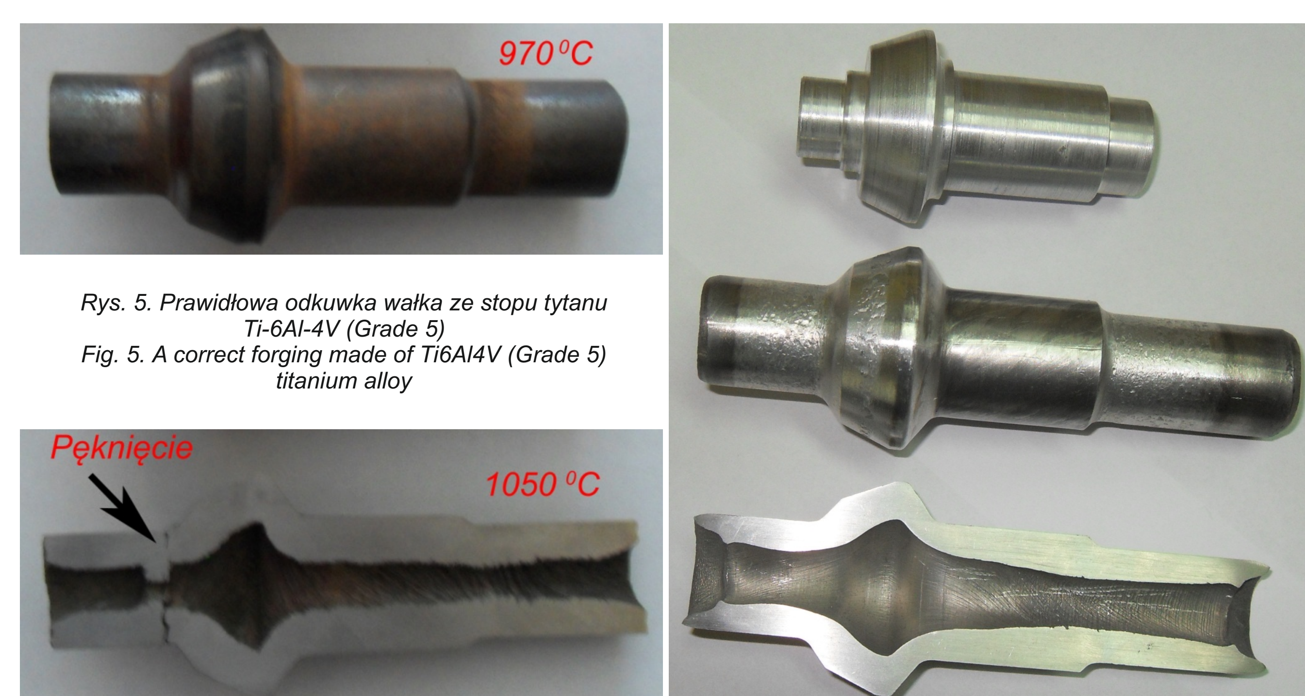
Rys. 7. Kształt gotowego elementu (u góry) oraz odcuwki pełnej i jej przekroju osiowego (stop aluminium 2618A) Fig. 7. A shape of the finished part (up), a complete forging and its axial section (2618A aluminium alloy)
