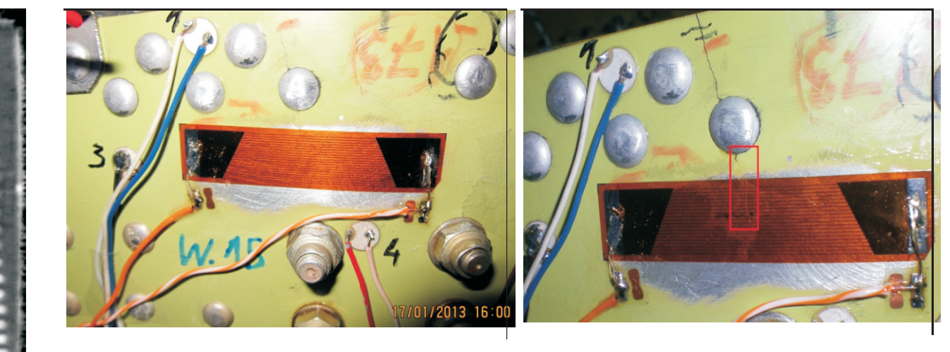
Rys. 13. Punkt pomiarowy z czujnikiem typu TFDBP1 przed i po rozpoczęciu propagacji pęknięcia Fig. 13. Measuring point TFDBP1 type sensor before and after the start of crack propagation
