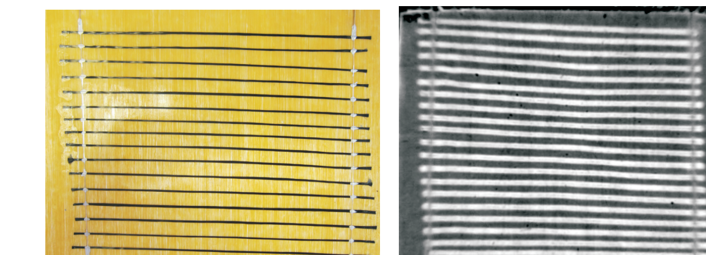
Rys. 11. Drabinkowy czujnik rezystancyjny utworzony z włókien węglowych Fig. 11. Resistive sensors formed from carbon fibers
