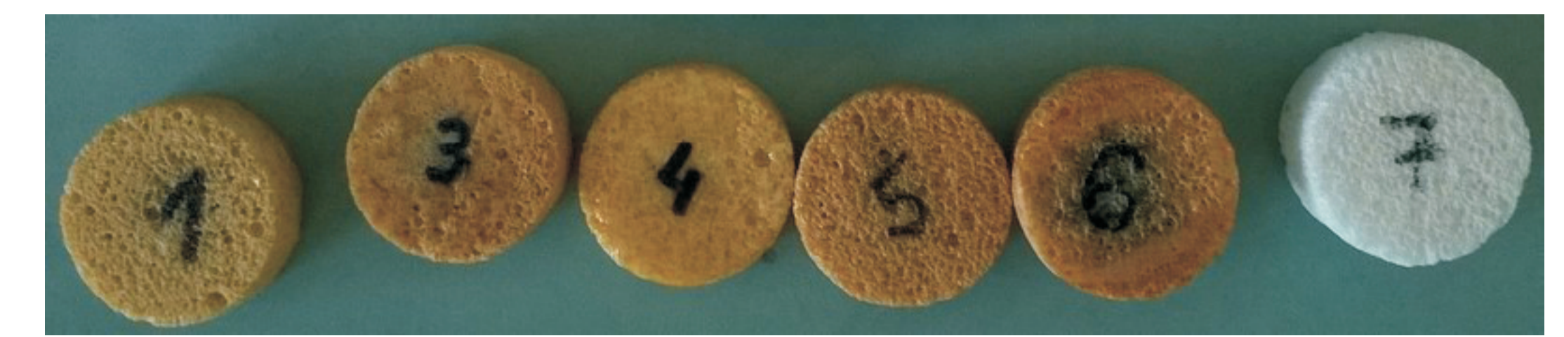
Rys. 1: Próbkę kompozytowe (S-1, S-3, S-4, S-5, S-6) wykonane z korundowej ceramiki porowatej z porami częściowo wypełnionymi żywicą oraz próbka czystej korundowej pianki ceramicznej (S-7) Fig. 1: Composite samples (S-1, S-3, S-4, S-5, S-6) made up from porous corundum ceramics with pores partially filled with epoxy resin, and a sample of pure corundum ceramic foam (S-7)
