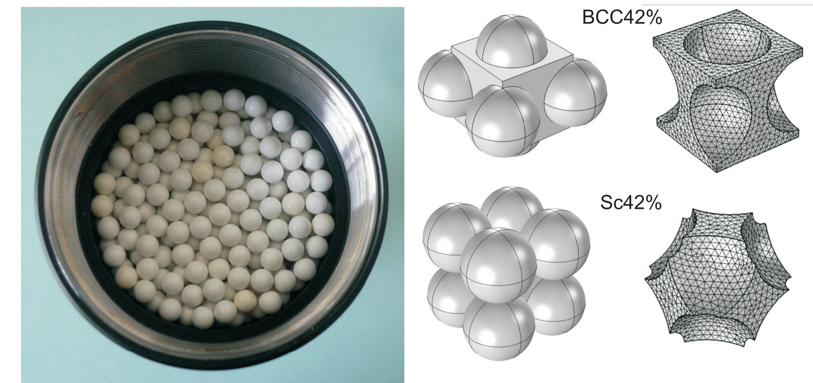
Rys. 4: Warstwa luźno upakowanych identycznych kulek (o średnicy 5,9mm) badana w rurze impedancyjnej oraz dwa typy komórek reprezentatywnych dla analiz mikrostrukturnych modelowania wieloskalowego: SC42% (upakowanie typu SC, porowatość 42% dzięki lekkiemu nasunięciu kulek) oraz BCC42% (upakowanie typu BCC, porowatość 42% dzięki lekkiemu rozsunięciu kulek) Fig. 4: A layer of loosely-packed identical spherical beads (with diameter 5.9mm) to be measured in the impedance tube and two types of representative cells used in the microstructural analyses of multiscale modelling: SC42% (SC sphere-packing with slightly overlapping spheres to adjust to the actual porosity of 42%) and BCC42% (BCC sphere-packing with spheres slightly shifted apart to adjust to the actual porosity of 42%)
