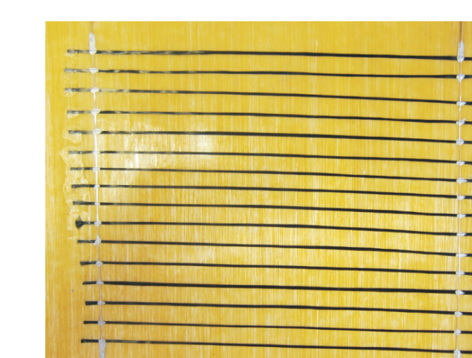
Rys. 11. Drabinkowy czujnik rezystancyjny utworzony z włókien węglowych Fig. 11. Resistive sensors formed from carbon fibers
