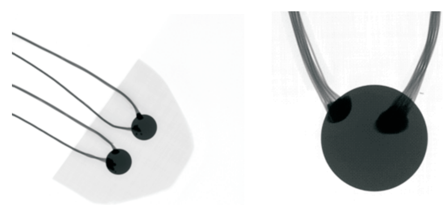
Rys. 3. Badania stopnia integracji przetwornika ze strukturą kompozytową za pomocą tomografii komputerowej (CT). Fig. 3. Testing the degree of integration of the transducer with the composite structure using computed tomography (CT).
