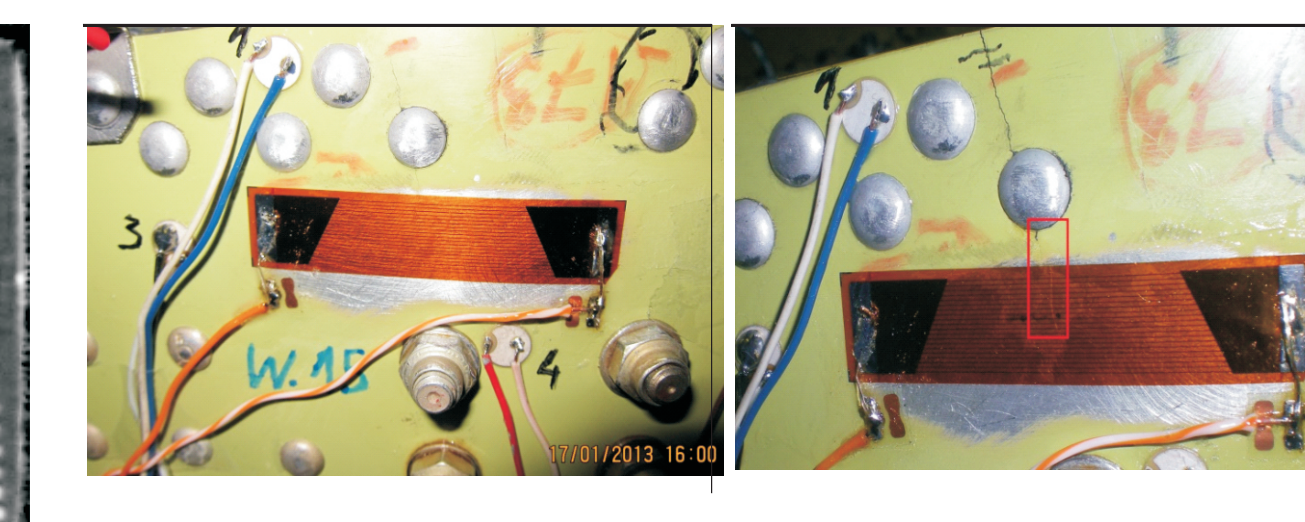
Rys. 13. Punkt pomiarowy z czujnikiem typu TFDBP1 przed i po rozpoczęciu propagacji pęknięcia Fig. 13. Measuring point TFDBP1 type sensor before and after the start of crack propagation
