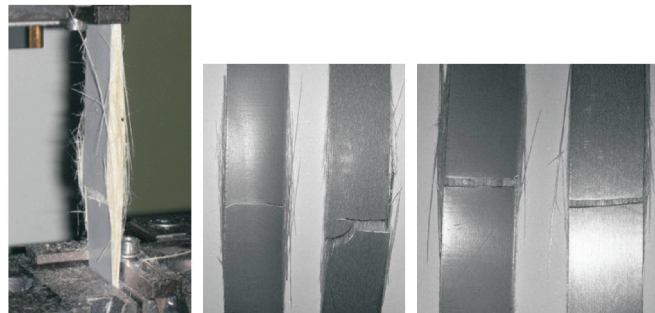
Rys. 5 Zdjęcia próbek po próbie statycznego rozciągania Fig. 5 The samples pictures after the static tensile test
